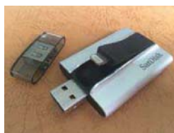
由于没有采用伸缩式设计，外部的塑料保护壳一定要妥善保管
