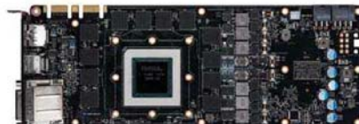
GTX 980Ti的PCB正面
