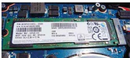
三星 512GB M.2 SSD 是 4K 版除了屏幕之外意义最大的一个升级点,它的体积与一根内存条差不多,有利于机身轻薄化设计
