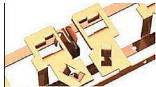
一体式铜套大大减小了排插内部的接触电阻
