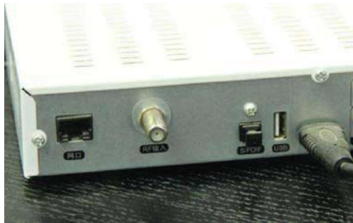
有线电视电视机顶盒背面的USB接口
