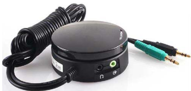
电位器损坏产生的噪音,可通过固定音量电位器,增加线控器来解决
