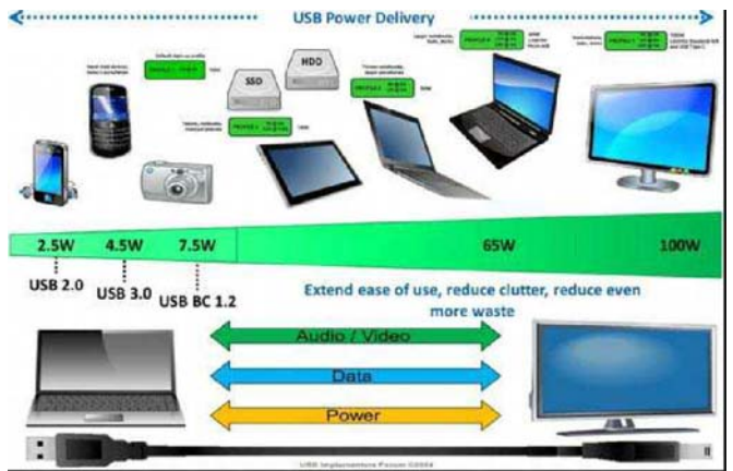
USB Power Delivery具有5种不同的组态
