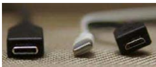
USB Type-C(左)、苹果Lightning和Micro USB(右)接口比较
