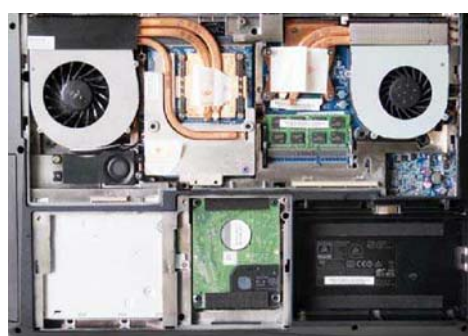
魔法师 M5 的维护非常方便,其中显卡采用了 MXM 接口,处理器也支持更换升级,再加上预留了 2 个 mSATA 和光驱位,可升级性很强
