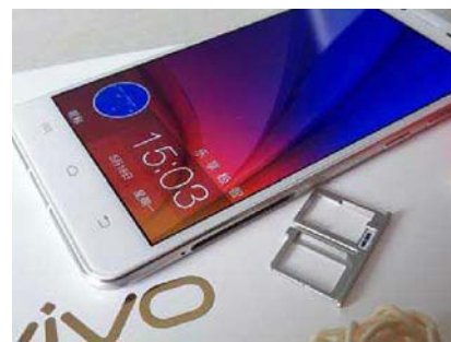
音量键、电源键以及卡槽都集中在机身右侧,双卡槽中的卡1采用了nano SIM卡和micro TF卡二选一的设置
