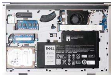
Inspiron 15 5000 金属版的内部设计很厚道,采用了框架结构对配件进行保护,不过该机内部并未预留任何升级接口,也有点遗憾
