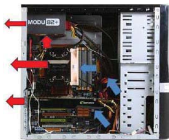
正确安装风扇时的风道图
