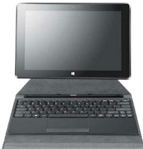
Sailing P10B 通过磁力吸附的方式让机身与键盘外套相连,磁力强度适中,这种方式相对其他分离式二合一产品而言可以获得更好的轻薄特性
