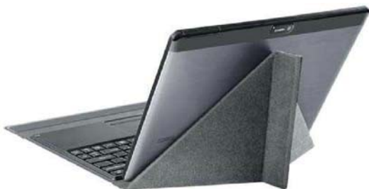
Sailing P10B 采用键盘外壳套支撑屏幕,在硬质桌面上的稳定性还不错,但这也意味着屏幕角度不可调
