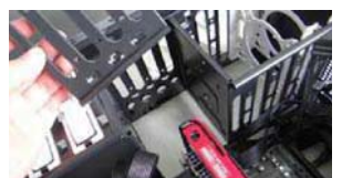
如果还想用更长的显卡,2.5英寸硬盘架是可以拆卸的
