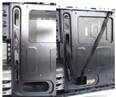
MVP Pro的4个3.5英寸硬盘位和3个2.5英寸硬盘位都是免螺丝安装的,非常方便
