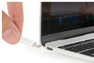
最厚仅 13.1mm 也就意味着机身接口的妥协,新 MacBook 机身除了音频输出之外,就只有一个 USB Type-C 接口,供电、数据交换、视频输出、连接扩展 HUB 全靠它,使用起来略麻烦,无法当作工作首选机使用
