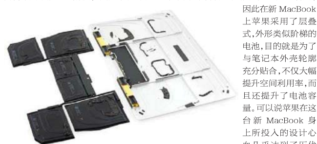
新 MacBook 的电池采用层叠阶梯式设计,目的就是为与外壳紧密贴合,尽可能利用内部空间并提升电池容量,这种追求极致的细节设计值得学习
