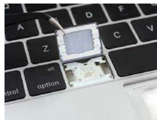
新 MacBook 采用了全新的蝶式支架,而宽大的键帽设计使得输入准确率较高,但键程短却是无法回避的问题,这个键盘需要时间去适应,但从设计的角度来说依旧是出色水准
