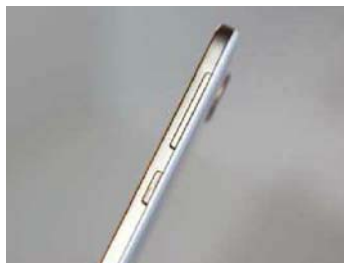
右侧音量键和锁屏键由于键程较短,看起来反而有些“隐蔽”,按压反馈手感不够明确
