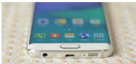
强迫症表示S6 Edge底部的充电接口似乎不在正中间感觉不能忍,Home按键集成了指纹识别功能,按压手感不错
