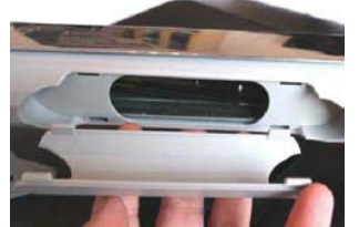
显示器支架上提供了走线槽,可以让显示器数据线和电源线从里面走
