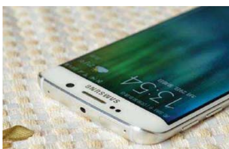
SIM卡槽在手机顶部比较少见,但这并不会对手机使用有任何影响,旁边的黑点竟眼看以为是耳机孔,实际是红外感应器
