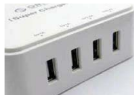
TPC-4A4U的每个USB接口都标注了最大输出电流
