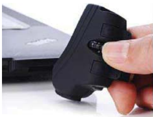
正确的使用方式,传感器在底部
