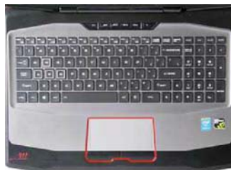
雷神911M-M1的键盘输入手感还算不错,但长时间玩游戏会在回车键附近形成比较明显的热量堆积,在25°C室温的情况下尚还能接受,好在这款产品能使用抽风式散热器
