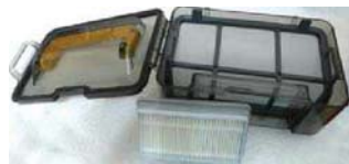
揭开顶盖就能看到垃圾箱(左),它是由滤网、外盒和内网构成的(内网是倒扣在外盒里面的,这张图不容易看出来)
