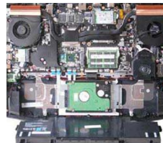
内部设计方面,雷神911M-M1还算中规中矩,各项维护的实施也比较方便,预留mSATA接口很实用
