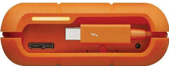
内置雷电数据线是 Rugged RAID 的特色,这种设计避免了丢失数据线的尴尬。除此之外该硬盘也支持 USB3.0 接口,这就意味着 Windows 笔记本也同样可以正常使用(但需辅助供电)
