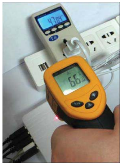
47W负载下,外壳温度最高处可达66°C——可见这一负载已经超越了“正常使用”范畴
