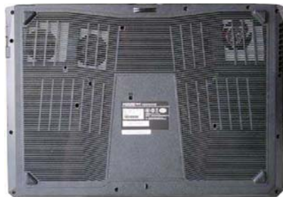
金属底盖在高端商用本中很常见,对于基本上不会放置于膝盖上使用的游戏本而言是个很棒的导热设计。而对于主流价位产品而言,多开孔的塑料底盖也是可以接受的(但前提是不要影响风道的完整性)
