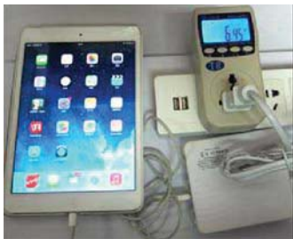
虽然可进行大功率充电(左),但这款7口产品给iPad mini 2充电时,功率却很低(右)
