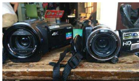
AXP35(左)的镜头处于“悬浮”状态,老一代XR550E(右)是镜片移动补偿,技术的迈进带来更稳定的拍摄效果
