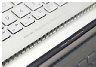
隐藏式出风口是高性能游戏本中最忌讳的设计方案,不仅效率低,而且还会完全阻碍辅助散热方案的实施
