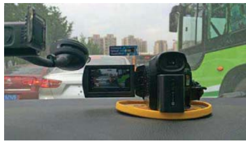
架在汽车前挡上测试防抖效果(未固定),视频防抖效果较好,颠簸感不明显
