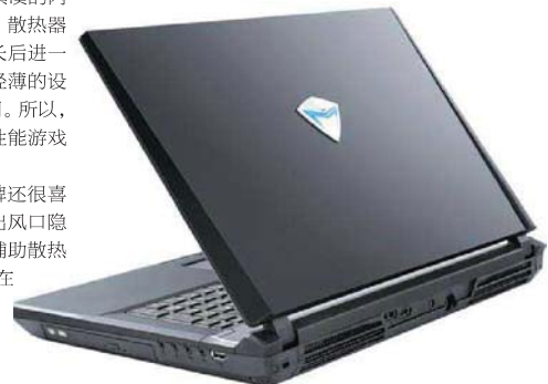
厚度足且屏幕开合不会遮挡出风口的方案更有利于配备抽风式散热器,在夏天可以很大程度上解决长时间玩游戏时的热量堆积问题
