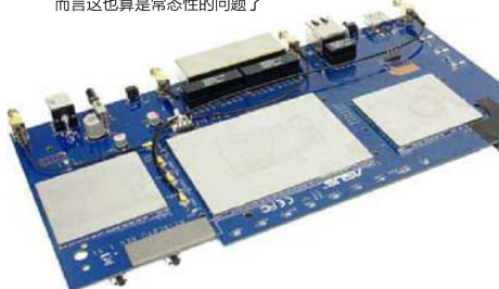
RT-AC87U 的内部走线很规整,负责 5GHz 802.11ac 信号输出的 Quantenna QSR1000 4 × 4 MU-MIMO 处理器平台以及负责功能扩展的博通 BCM4709A 处理器的双管齐下,让该机的性能达到很高水准
