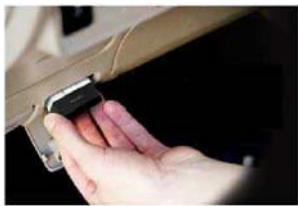
每款车的 OBD 接口位置不同,通常都在驾驶座位的下方,找到接口后,将 AutoBot 对准插入,它就会亮起红灯
