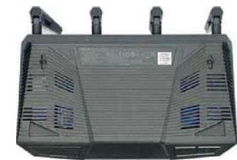
该机底部采用了多开孔散热设计,在实际使用过程中中发热量可不低,不过对于大多高端产品而言这也算是常态性的问题了
