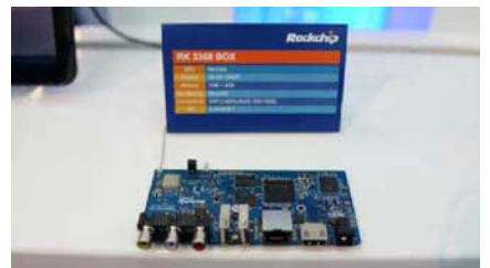
搭载 RK3368 处理器的主板初现, 最大的亮点是采用 64bit 八颗 Cortex-A53 核心架构
