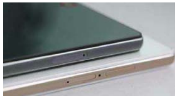
可以看到两款手机侧面开孔的不同,由于TF卡槽被移到背后,Z9 mini侧面要少一个开口
