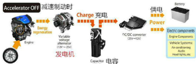
宝马的减速制动时的能量回收系统示意图
