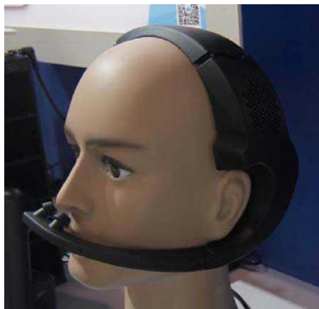
“风小六”的头部是进风口和净化器,出风口则直接对着鼻孔
