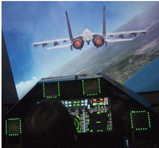
战斗机模拟舱,当进行拉起俯冲等操作时,机舱会随之运动,从而营造更真实的感受
