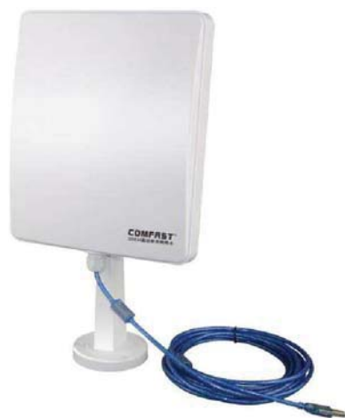
在使用高增益天线后,远距离传输时易出现信号良好,却无法上网的情况
