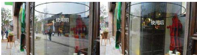
偏振镜(偏光镜)可以滤掉目标上一部分特定的反射光线,整体亮度变化不大
