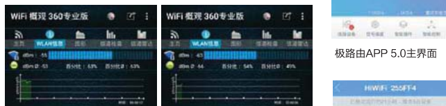
图左为2.4GHz WiFi,图右为5GHz WiFi(下同)。无墙壁阻隔,距离约8米,两者表现都较优秀,2.4GHz WiFi的信号强度能达到-47dBm
