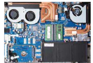
战神 Z7M 可以直接揭开底盖进行维护,很方便。GTX 965M 显卡配备了双风扇三热管方案,处理器端则采用了单风扇双热管散热,除此之外该机还预留了 2 个 M.2 接口方便升级 SSD
