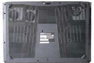
该机的底盖采用镂空设计比较有趣,对冷空气流通有一定的辅助作用
