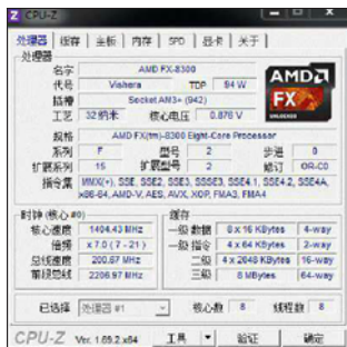
FX-8300 在闲置时 CPU 频率还会自动降到 1.4GHz,进一步降低功耗
