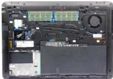
维护方便是高端商用本一贯的特色,ZBook 14 G2 可免工具打开底盖和电池,并且预留了 3G/4G 模块升级位和标准 SATA3 接口,可升级性很强
