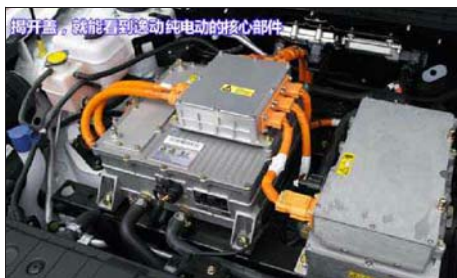
图中为控制组件,电机在下面
