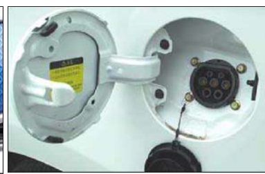
左图是为充电站准备的前置充电接口;右图是为充电桩和家充准备的车身充电接口。充电站0.5小时就能将电充满;充电桩和家充(可理解为220V市电)要8小时
