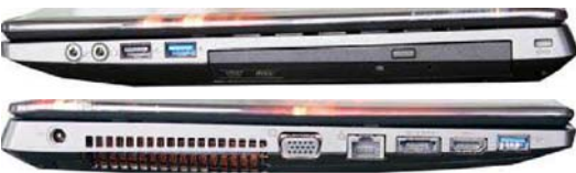
对于一款游戏本而言,M520A的扩展功能还算全面,而且保留了光驱位,USB2.0用来连接鼠标或U盘安装操作系统都有更好的兼容性
