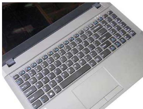
M520A的输入体验还算不错,没有特别让人难受的地方,不过该机在长时间玩游戏的情况下左腕托和空格键附近热量堆积比较明显,需要注意劳逸结合
