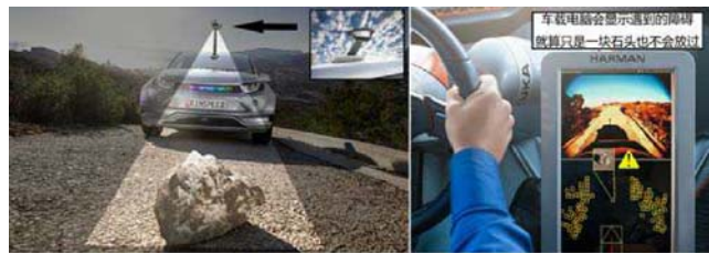
即便是路上一小块石头,Budii 车顶上的雷达也能探得一清二楚,并在液晶屏上进行提示
