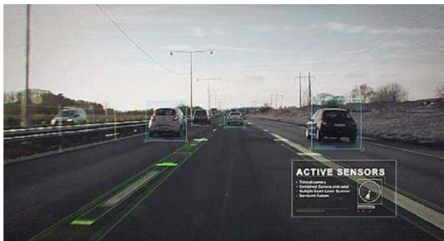
通过传感器传输的实时信息,系统可自动识别前方车辆从而做出超车、跟车、减速甚至是停车的操作
