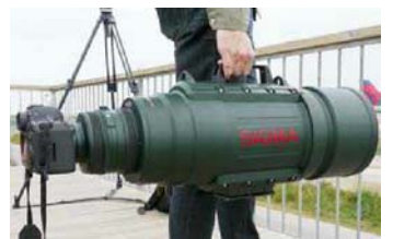
如果是变焦镜头,连200-500mm F/2.8都得做成这个样子,30多斤的体重已经突破了人类用户的手持极限,大家想象中的18-500mm F/1.8应该只能在潜水艇上使用了……
