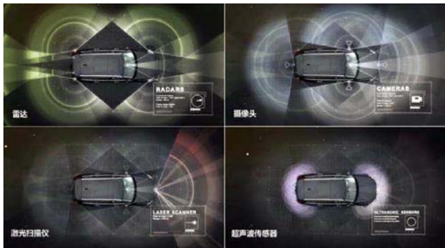
多种类型的传感器保证了XC90自动驾驶系统能够全方位无死角地感知周边环境
