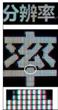
相机拍摄 D42A561U 屏幕文字,“率”字屏宽宽度约 1cm,横向 43 个像素点,放大后可见每个像素点由蓝、绿、红 3 个颜色构成。D42A561U 物理屏宽 91.8cm(可显示范围),由此计算,的确是 3840 个物理像素点
