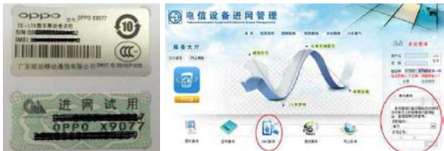
从电池仓查看进网许可证和IMEI编码,工信部网站提供了许可证以及IMEI编码查询功能
