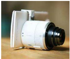
和QX系列一样,O-lens1的背部也设计了可折叠的手机伸缩卡夹,最大可伸展80mm,我们试过宽度77mm的OPPO N3也可牢固夹住,但拆的时候就不太好拆了
