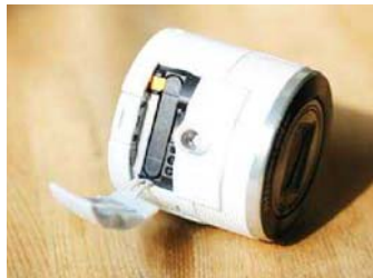
电池仓旁边有一个三脚架接口,这表明它还可以接收三脚架及更多配件使用,实现更多的使用场景扩展
