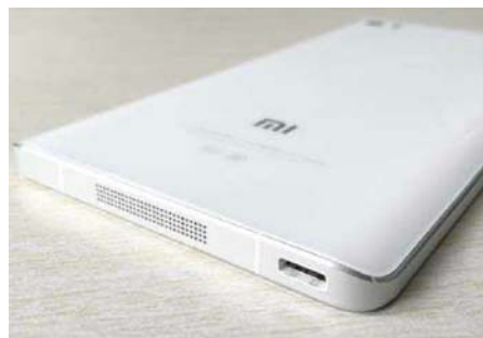
数据线接口位于机身左下方,几乎与上方的3.5mm音频接口对称,同时使用时会对无法旋转的横屏应用造成不便
