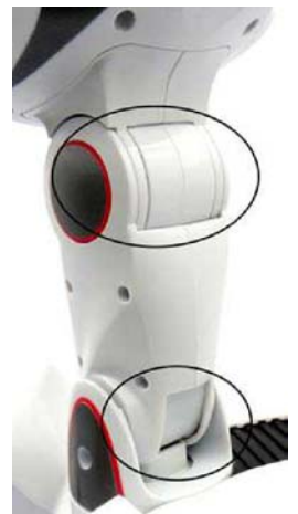
颈部配备了两个关节,各由一个电机控制
