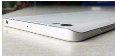
虽然机身厚度仅为6.95mm,但小米Note的摄像头没有凸起,完全与机身持平
