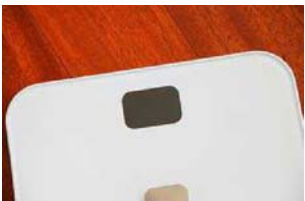
RyFit采用重量感应式设计,平常处在休息状态,仅在检测到上方有超过5kg的重物时,屏幕才会亮起,其本身不需要开操作
