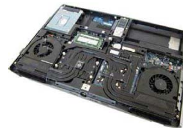
X599的维护很容易,内部设计紧凑,六热管双风扇散热效率很不错。而且该机的内部可升级性非常好,标准SATA3接口和mSATA接口均有预留,还能继续升级2条内存(键盘下方)
