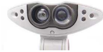
Roboquad 的头部配备了红外发射器和接收器(就是两只眼睛),眼睛两边是闪光灯和头灯
