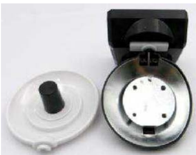
“锅盖”款无线网卡拆开之后可以看到金属的定向天线,只是在测试中这么夸张的天线设计似乎并没有带来多大的性能提升,和“门板”款相比有一定差距
