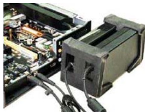
由于采用了旗舰级显卡,华硕G20不得不为显卡设计专用供电适配器,不过坦率说,G20的供电设计显得有点草率
