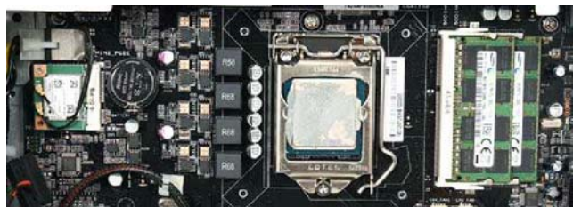
采用混合平台是几乎所有小型化PC的必经之路,华硕G20也不例外,它选择了笔记本平台的内存与无线网卡,但维护起来则需要拆下其他配件,有点麻烦
