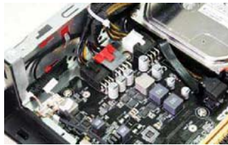
在G20内部,设计了6pin与8pin辅助供电接口,这也为诸多高端显卡的更换提供了方便
