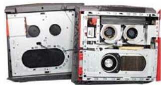
作为一款超迷你游戏PC,G20在很多设计特性上都与此类产品的“开山之作”Alienware X51有相似之处,但前者为全长度双槽顶级显卡预留了充足的空间,这一点值得称赞
