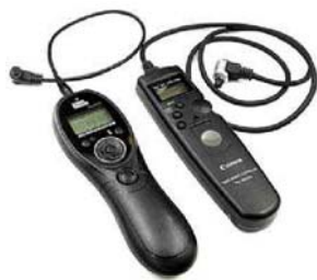
右为佳能原装快门线,只能拍摄 99 张(坑爹啊!),左为国产快门线,可以连续拍摄无限张
