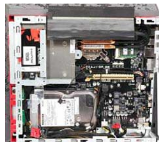
受限的空间让玩家自行增加配件的可能性大幅降低,甚至可以说华硕G20就没有任何的升级性而言,维护起来也相当麻烦
