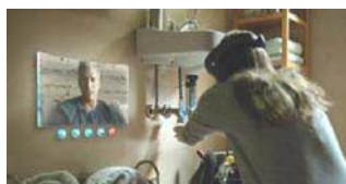
体感采集和智能眼镜相结合,工程师甚至可以“手把手”教你修水管
