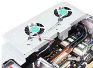
散热器方面沿用了笔记本热管+散热风扇的设计思路,实现了扁平化,更好地利用内部空间,有利于小型化。当然,在风扇尺寸上比笔记本的要大一点,效率也还不错
