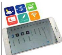
买来的手机 NFC 标签往往有场景标注,睡觉、会议、驾车、WiFi(连接信息)、名片(信息)……大家可根据文字提示赋予标签对应的功能,这样做的好处是易于区分,不会弄混淆
