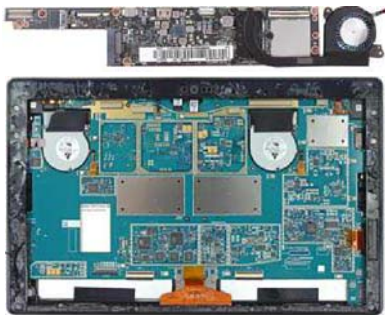
Core M处理器的超低功耗设计让它具备了PC小型化的一切条件,联想Yoga 3 Pro(上)的主板面积比采用17W TDP处理器的Surface 3 Pro(下)小了很多
