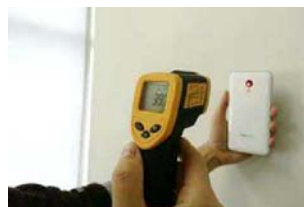
近一个小时高强度测试后,机身温度最高处没有超过40℃,发热量控制没有问题
