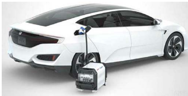
本田FCV Concept可以使用外部充电器充电,也能逆向变为发电机
