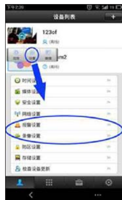
点击设备列表中的设备名称处(不要点视频画面处,这样会进入连接状态),在弹出菜单中选择“设置”,就能在对话框中进行报警设置和录像设置了
