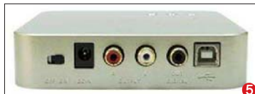
图4 后面主要是输入输出接口。除了电源开关之外,就是音箱左右RCA输出接口以及同轴数字输出接口。当然,所有数据的输入,都是靠USB接口,只不过后面的做工看上去实在有点粗糙,有些小瑕疵。要知道从这款产品的规格指标来看,已经是节奏坦克目前在市面上销售的最高端的音频产品了。
