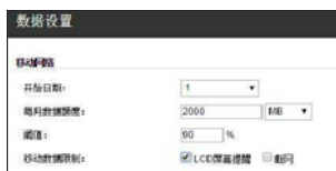
当流量使用达到一定数值后,可以设置通过屏幕提醒或让瑞酷 LR112A 直接断网
