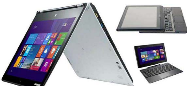
从 2012 年开始的复杂变形,到后来分离式设计的妥协,再到 Broadwell Core M 处理器带来的无风扇超轻薄化革命,正是硬件平台技术的不断成熟造就了二合一产品躺下去的日渐合理
