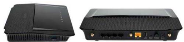
D-Link DIR-880L在机身侧面有一个USB 3.0接口 机身背面还有一个USB 2.0接口
