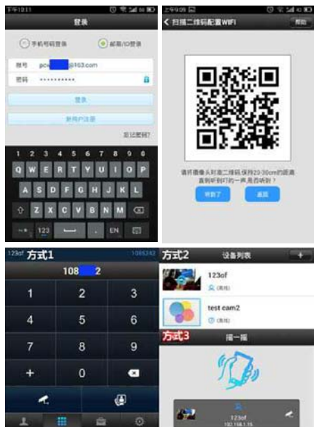
APP需要注册并登录才能使用。无线信息通过二维码发送给IPC-06
