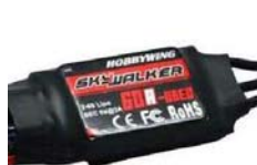
最高支持60A电流的电调
