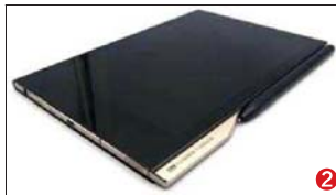
图2 T9的材质有金属和塑料两种,左边弧形的塑料材质和屏幕接合得很好,以一种包裹的姿态,将上方、下方以及左侧的金属围住,观感很舒服。金属部分则使用了6系铝合金,一体化的屏幕贴合工艺给T9更增添了不少视觉上的享受。如果单从外观和设计而言,T9绝对算得上是国产平板中的亮点作品。
