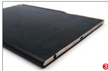
图3 一款商务平板显然不会特别突出娱乐扩展功能,所以T9的接口都是很中规中矩的,没有HDMI接口,整机就只有耳机、USB、音量控制以及电源几个最基本的接口。当然,T9本身还是一款通话平板,采用高通的基带方案,支持目前所有4G及主流3G网络,甚至连电信的CDMA格式都支持,所以它也有Micro SIM卡的接口,和苹果手机的使用方式相同。
