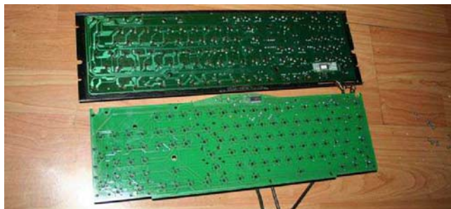
MX-BOARD 2.0(下)电路板更简洁,PLUM键盘(上)内衬有铁板,稳定性更高
