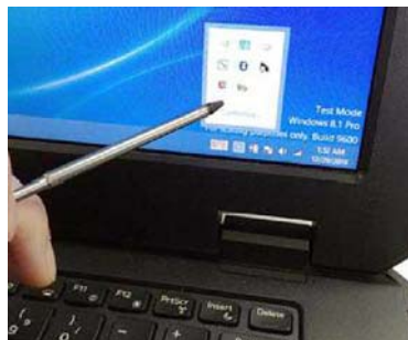
响应准确快速的电阻屏让触控操作变得更多样化,既可以配合自带的触控笔,也可在严苛环境下戴着手套操作(有雨水时,电容屏就会“出状况”,基于压力感应的电阻屏这时就反而显得稳定了)
