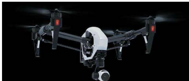
大疆的“悟”系列可以在没有 GPS 信号的室内通过“视觉定位”实现定点悬停
