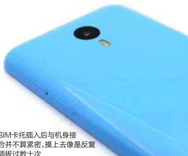
单托双槽的SIM卡槽设计,不支持存储卡扩展
