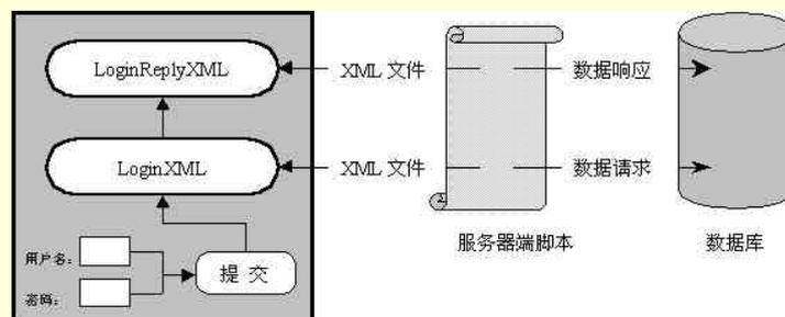
图 10-17 XML 交互流程图
