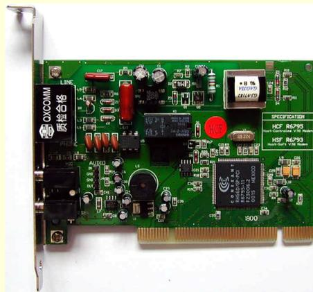
图 11-2 PCI 接口的内置 Modem
