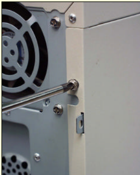
图 15-1 将机箱背部的螺丝拧下
