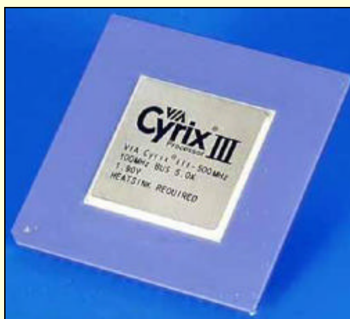
图 2-2 CPU 的表面上标有它的主频
