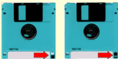
图 9-4 软盘的两个状态，其中左图处于写保护状态
