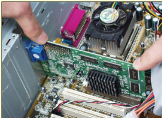
图 15-37 将显卡插入 AGP 插槽中
