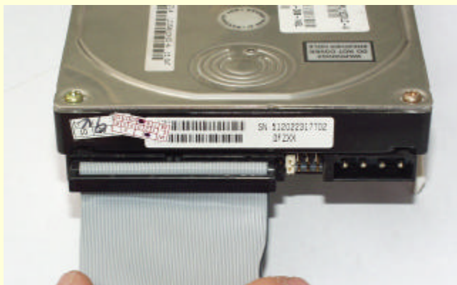
图 15-32 连接硬盘数据线
