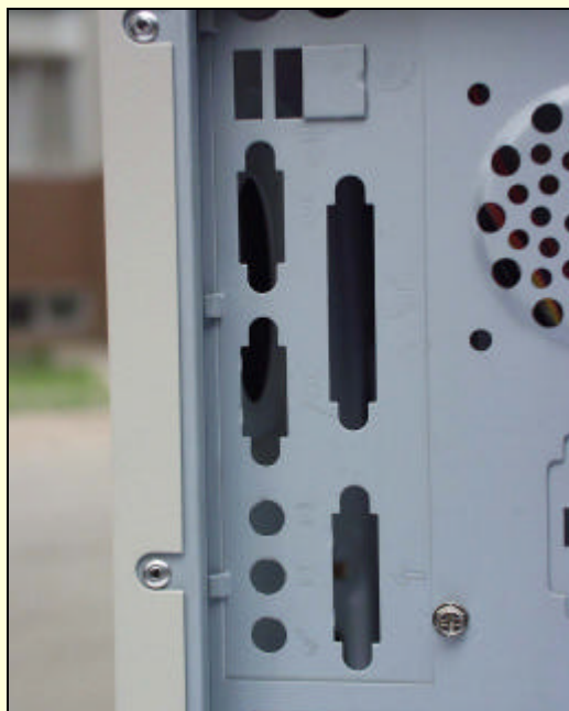
图 15-3 扳掉缺口上的铝片
