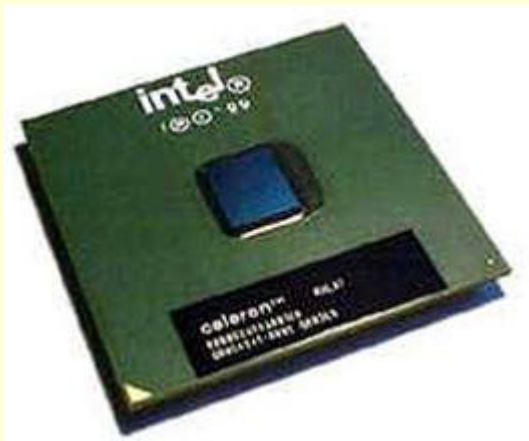
图 2-6 FC-PGA 封装的 Celeron
