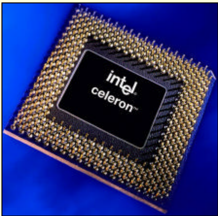
图 2-5 PPGA 封装的老 Celeron
