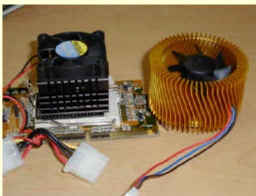
图 2-25 不同的风扇散热效果差异很大
