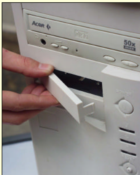
图 15-25 卸掉软驱安装预留空间前挡板
