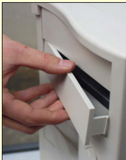
图 15-17 卸掉光驱安装预留空间前挡板
