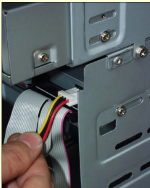
图 15-28 连接软驱电源线
