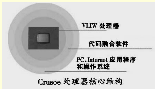
图 2-23 Crusoe 处理器的核心结构
