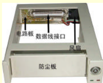
图 5-22 内置硬盘抽取盒的框架部分
