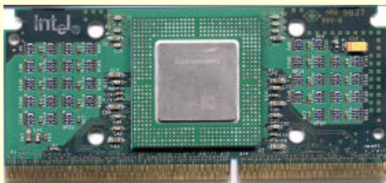
图 2-7 Slot1 接口的 Celeron
