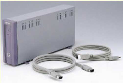
图 5-12 外置的 IEEE 1394 接口硬盘和连接线
