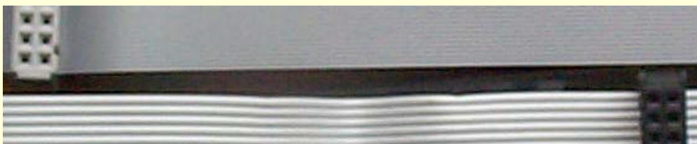
图 5-8 两种数据线线数相差一倍
