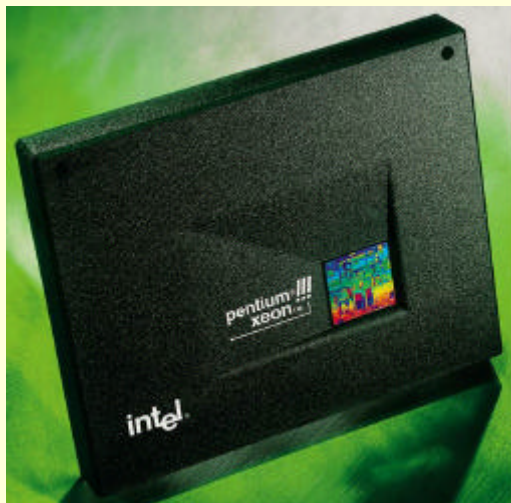
图 2-24 用于服务器的奔腾三 Xeon 处理器
