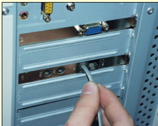
图 15-53 将连线的一端插入 Line 插孔
