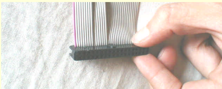
图 10-60 FDD 数据线的插头
