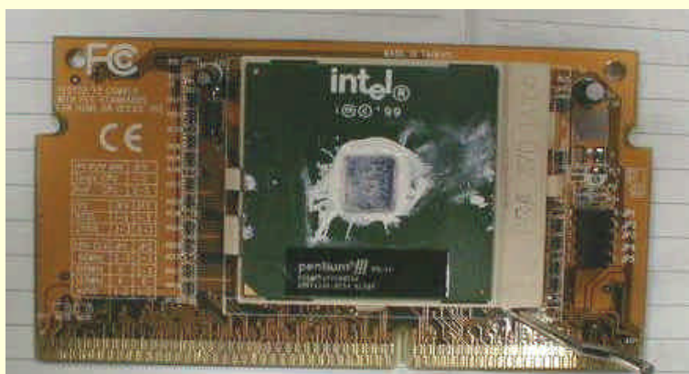
图 10-22 铜矿 CPU 已经放入插座内
