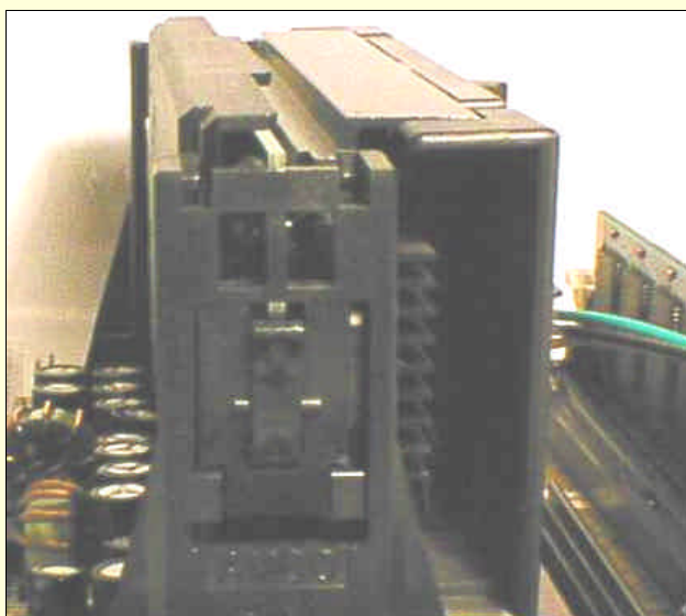
图 10-16 CPU 支架上的卡子
