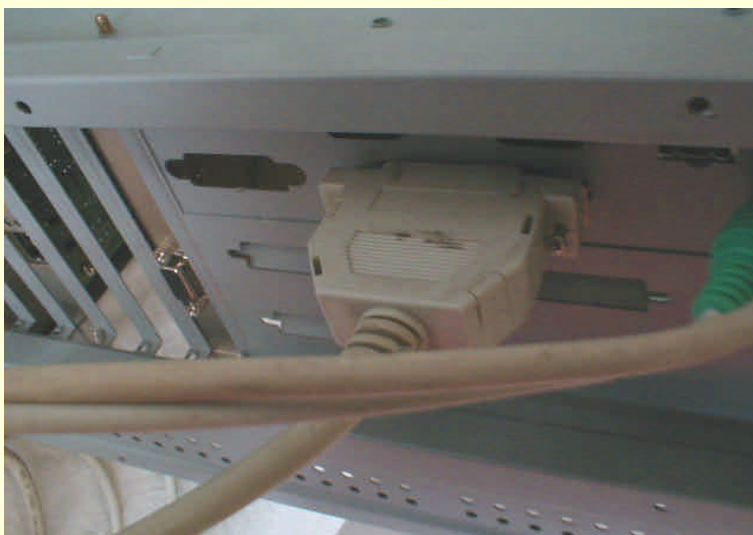
图 13-27 连接打印机数据线
