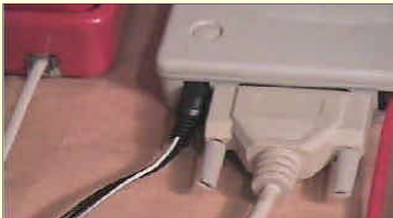
图 15-7 连接好 9V 的电源线
