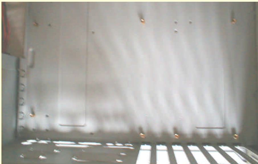
图 10-41 机箱底板上的对应的螺丝位置
