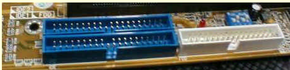
图 2-22 主板上的软驱接口和 IDE 接口
