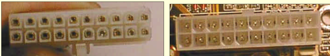
图 2-21 主板上的 ATX 电源插座与 ATX 电源插头
