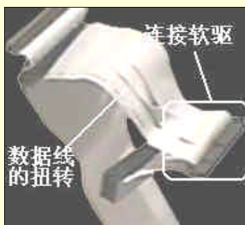
图 10-61 软驱数据线在连接软驱 A 的那边有一扭转
