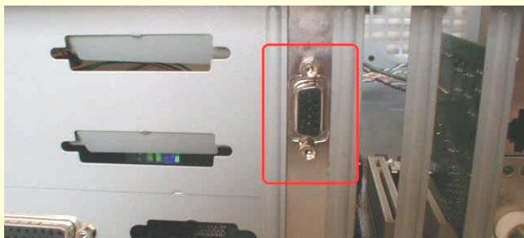
图 10-83 显示卡接显示器的输出端口
