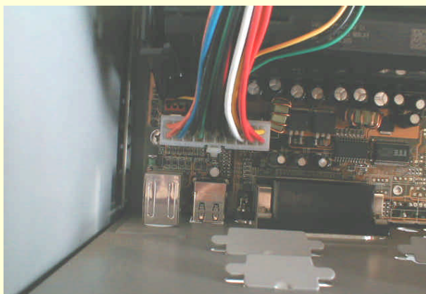
图 10-47 ATX 主板电源安装完毕
