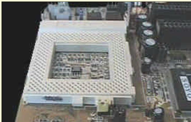
图 10-32 SOCKET7 插座及拉杆
