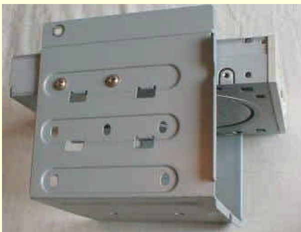
图 10-50 安装完毕的软盘驱动器和 3.5 寸设备支架
