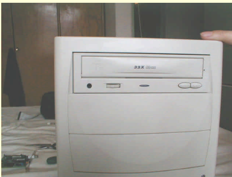
图 10-69 将光驱放置到合适的位置
