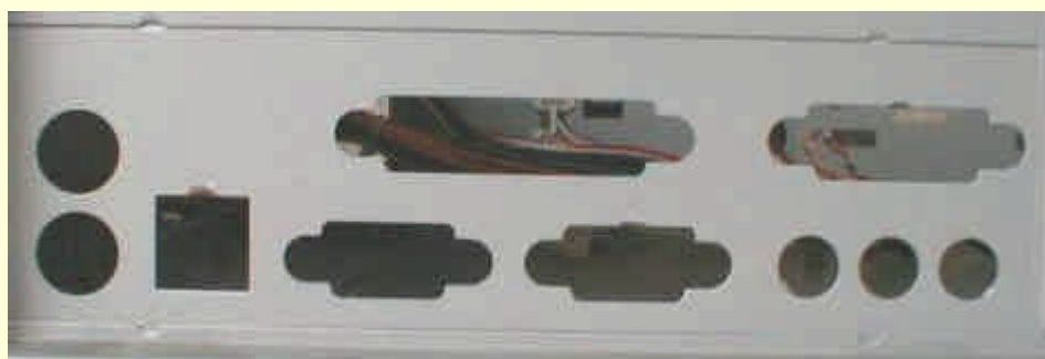
图 9-4 ATX 机箱的背面示意图
