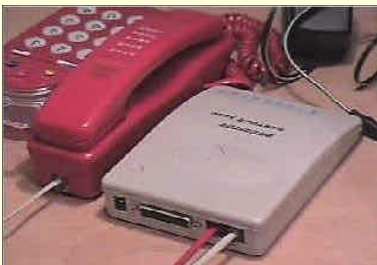
图 15-4 将调制解调器和电话串联
