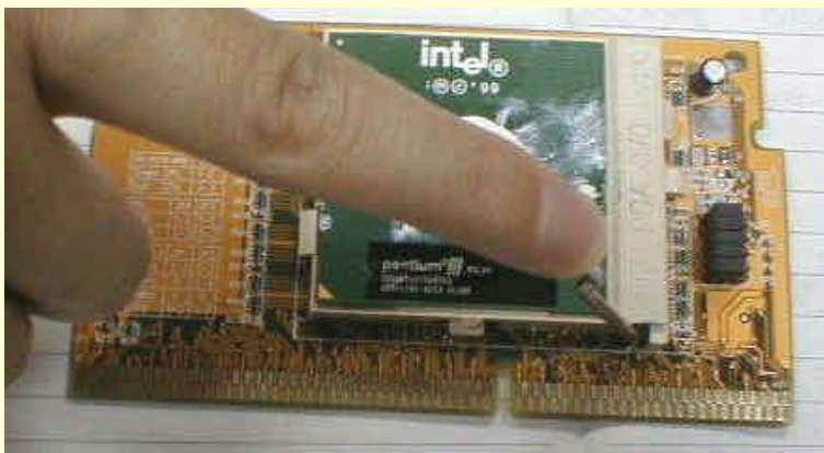
图 10-23 推上拉杆，固定 CPU
