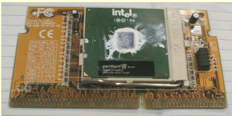
图 10-24 CPU 安装完成
