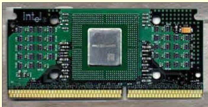
图 3-7 Celeron SLOT1 CPU 看上去就象一块扩充卡
