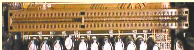
图 10-13 SLOT1 槽中间的横杠
