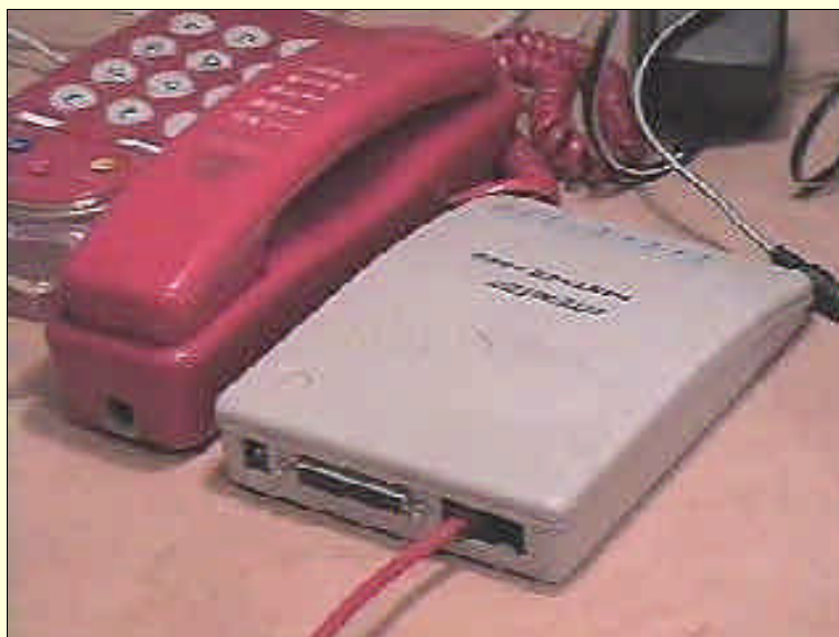
图 15-3 与电话线相连接的调制解调器
