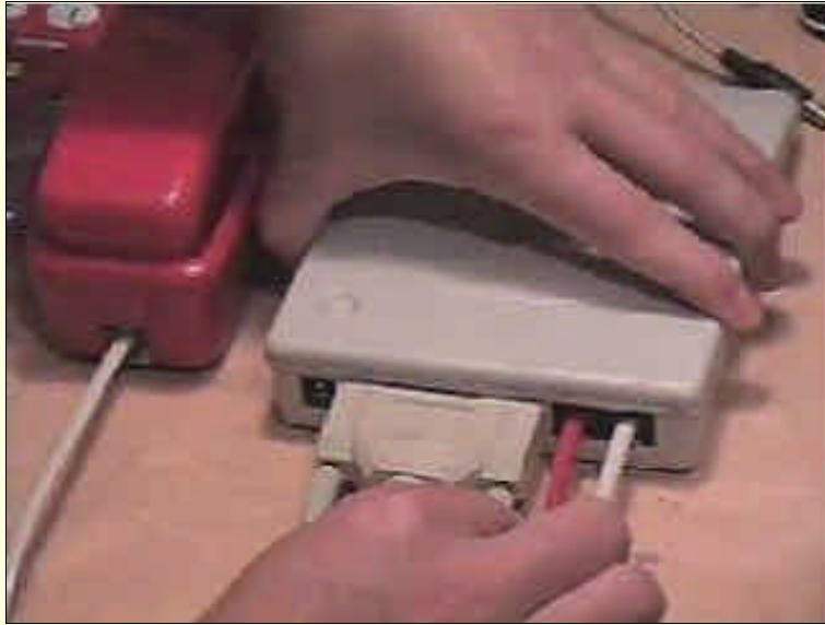
图 15-5 将数据线接到调制解调器上
