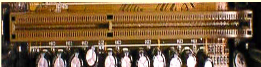
图 2-8 SLOT1 CPU 插槽，大有一统江山之势
