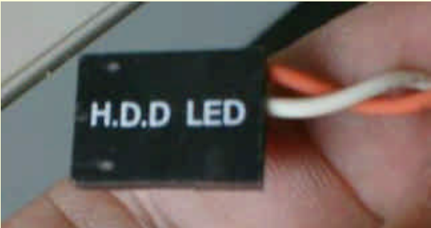
图 10-80 硬盘指示灯插上清清楚楚的标记，可惜是英文简写 我们给出图中英文简写的翻译如表 10-1 所示：
