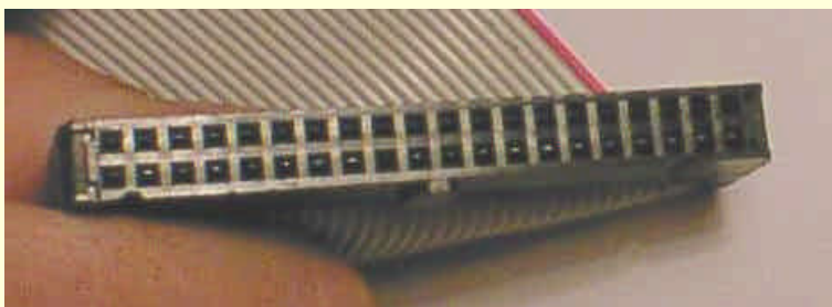
图 10-62 硬盘数据线插头也有突起
