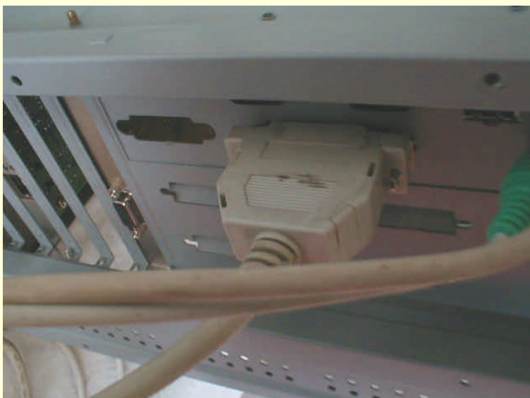
图 14-3 将并口线连接到并口
