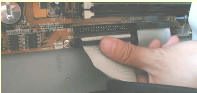
10-64 将硬盘数据线插到主板的 IDE 接口上
