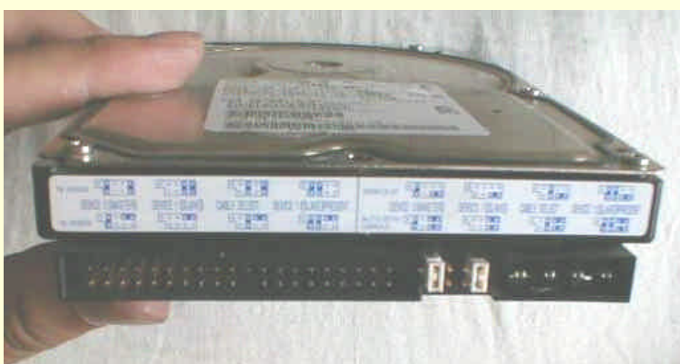
图 10-52 硬盘接线端的跳线图
