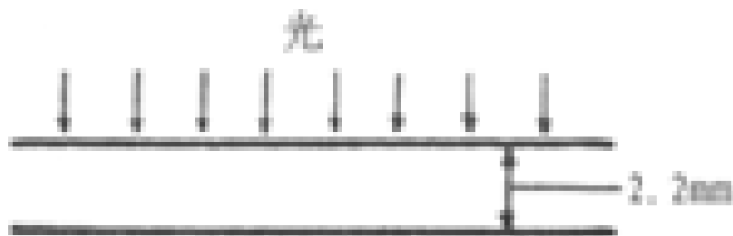
图 5—3 玻璃滤光器示意图
