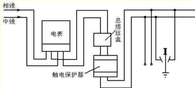
在安装漏电保护器时，应记住在漏电保护器保护的范围内，零线不能重复接地，设备也不允许接零，但均可以接地，如上图中的三线插座就有接地装置。由于公用电网均采用接地保护，因此并无冲突。
