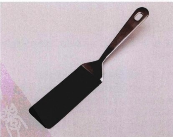
图6-9 光源在抹刀反射的角度系外，金属表面没有直接反射，因此抹刀在图像中呈现黑色
