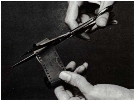
图 6.8 用剪刀剪去胶片的导片头
