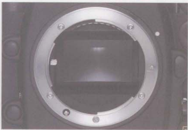
◆ 取下镜头，看到卡口内的是反光镜而不是影像传感器
