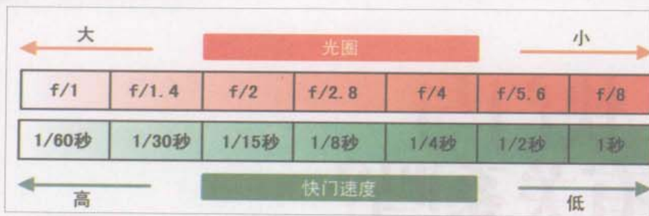
◆ 光圈和快门的的关系示意图
