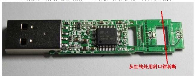
剪短后的实物,如 PCB 留得过长,则后面无法进行完美装配
