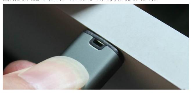
装好尾塞后,正反面的样子如下图,无溢胶现象,也无明显缝隙,过 10 分钟左右,待胶水完全干后就可放心的使用 U 盘了。
