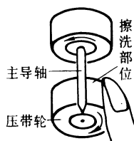
图1 清洗压带污垢
