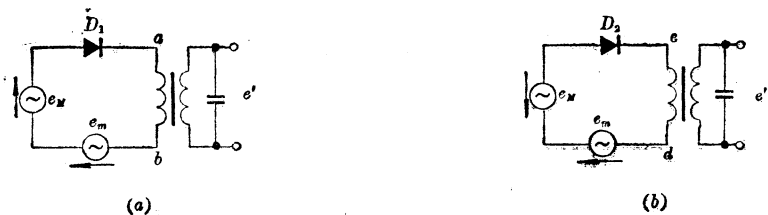
图 1-19 两个二极管调幅器
