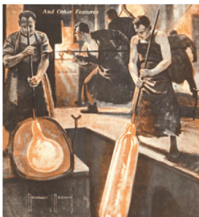
1920年，先吹出一个玻璃圆筒再做成窗玻璃，直到今天，仍然有人使用这种工艺。
