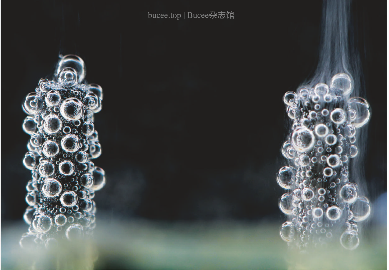
电极在电解槽中将水分子隔离成“氧（左边）和氢（右边）”两个部分。电极高约一厘米。
