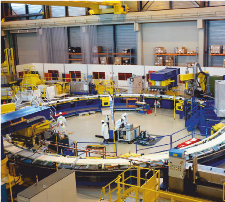
工人正在组装用于 ITER 的超导磁铁。
