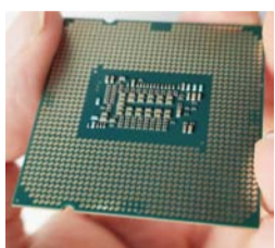
编号SRH3D,步进为G1,背面阻容元件排列如图的Intel酷睿i5 10400F可能采用硅脂填充
