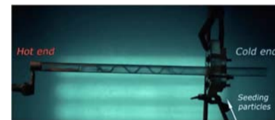
气体在涡流管内部形成了双螺旋
