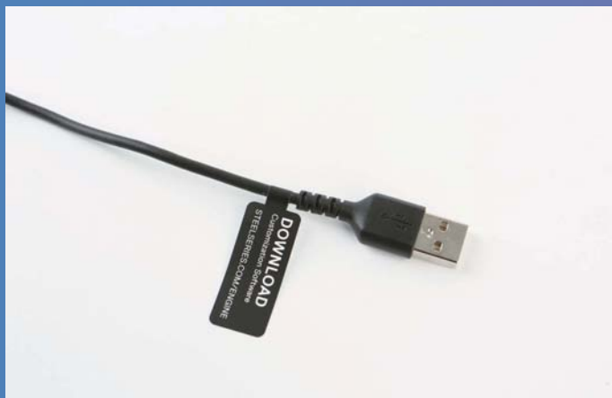
线材方面，赛睿Rival 3游戏鼠标采用了橡胶材质，并且接口没有进行镀金处理。
