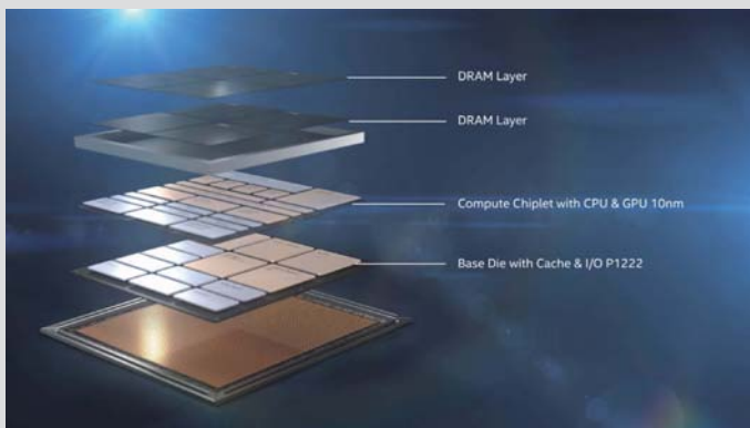
■ Lakefield分层示意图, 可见基础模块和计算模块。
