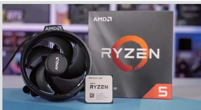
■ 6核心、12线程设计的锐龙5 3600最高加速频率可达4.2GHz，AMD还附送了“幽灵”潜行Wraith Stealth 65W静音版散热器。
