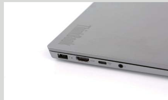
>> USB Type-C 接口支持关机充电、数据传输以及视频输出，更重要的是这个接口还支持 65W 充电。
