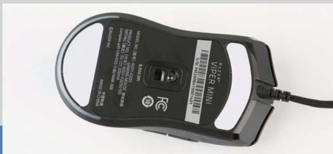
■ 鼠标底部拥有两块面积适中的PTFE脚贴，摩擦因数颇低的PTFE材质能为鼠标提供不错的顺滑度。
