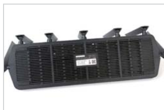
>> 小米AIoT路由器AX3600的冷空气进风口几乎占据了整个机身底部
