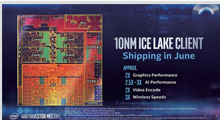
Ice Lake核心晶圆图，实际上Lakefield的计算模块和Ice Lake核心非常相似。
