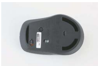
>> 雷柏M300S多模式无线充电鼠标的底部设计了一颗蓝牙开关和电源开关，并且充电接口也在鼠标底部。
