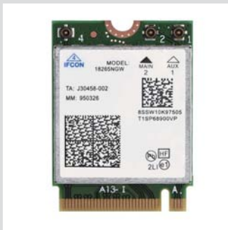
■ M.2只是一个接口规格，适用于多种设备，图为M.2 Wi-Fi扩展卡。
