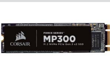
■ 采用BM类型接口的美商海盗船MP300 SSD，只支持PCIe 3.0 x2规格。
