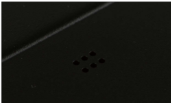
顶部设计有一个麦克风，用于感知环境声音，从而变换机箱灯效。
