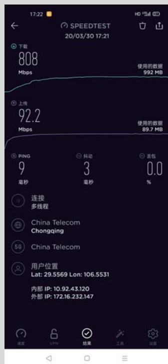
>> 实测下行速率 808Mbps，上行速率 92.2Mbps，5G 连接速度较快且稳定，抖动较小。
