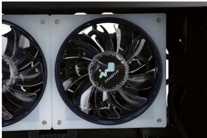
预装的风扇外部采用了软胶进行包裹，从而降低噪音。
