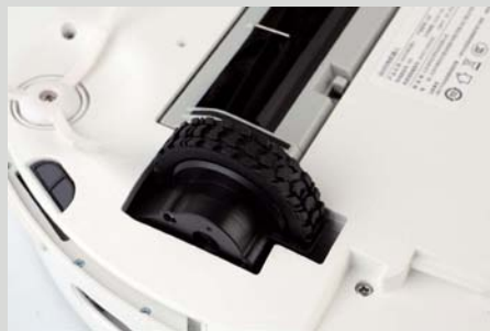
>> 在底部轮胎的设计上，X90 拥有花纹很深的防滑胎纹，可以轻松越过电线等障碍物。
