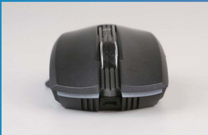
雷柏V20 Pro游戏鼠标采用了有线、无线双模设计，所以它的前脸部分还有一个Mini USB接口。
