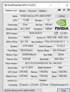
RTX 2060 SUPER的核心代号为TU106-410, 它的核心基础频率为1470MHz, 核心Boost频率为1650MHz, 同时RTX 2060 SUPER拥有8GB GDDR6显存容量。
