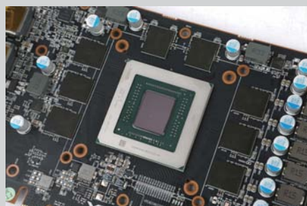
RX 5700 XT核心采用了AMD新一代RDNA架构, 它的核心基础频率为1605MHz, 核心Boost频率为1905MHz, 同时RTX 2060 SUPER拥有8GB GDDR6显存容量。
