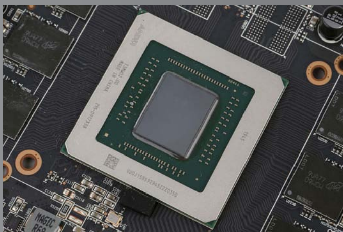
GTX 1660 Super搭载的TU116-300核心基于NVIDIA最新的图灵架构
