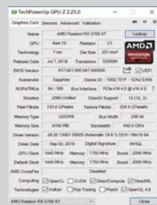
RX 5700 XT核心采用了AMD新一代RDNA架构, 它的核心基础频率为1605MHz, 核心Boost频率为1905MHz, 同时RTX 2060 SUPER拥有8GB GDDR6显存容量。
