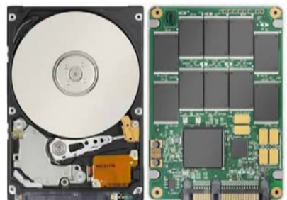
机械硬盘(左)与固态硬盘内部结构(右)
