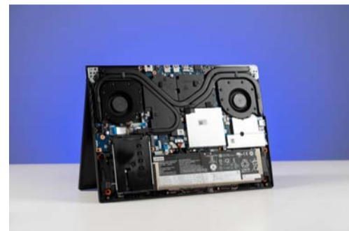
内部设计做工规整,散热为双风扇三热管+四出风口设计
