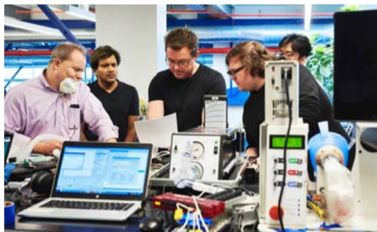
工程师对简化呼吸机进行测试
