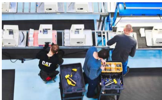
技术人员组装呼吸机的顶部底盘
