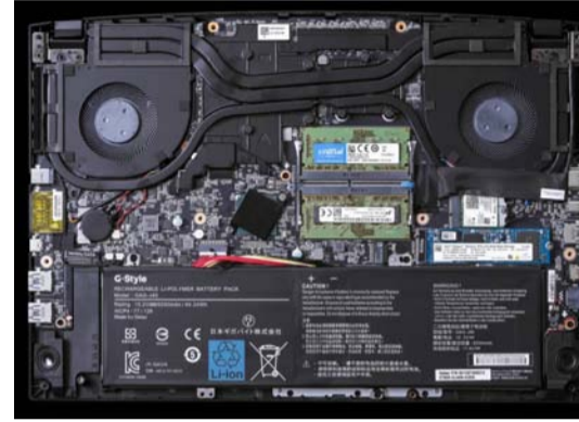
▲技嘉新AERO 15 OLED的内部设计,整体规整,双风扇五热管,其中一根热管隐藏在背面,电池容量94Wh,预留一个M.2硬盘位
