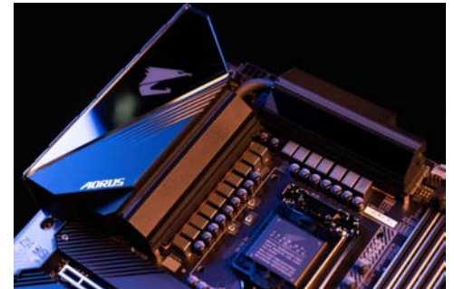
Z490 AORUS XTREME将供电规格提升到超越自家旗舰级HEDT平台的水平(单相供电高达90A,总输出高达1440A),是Core i9 10900K极限超频的终极利器
