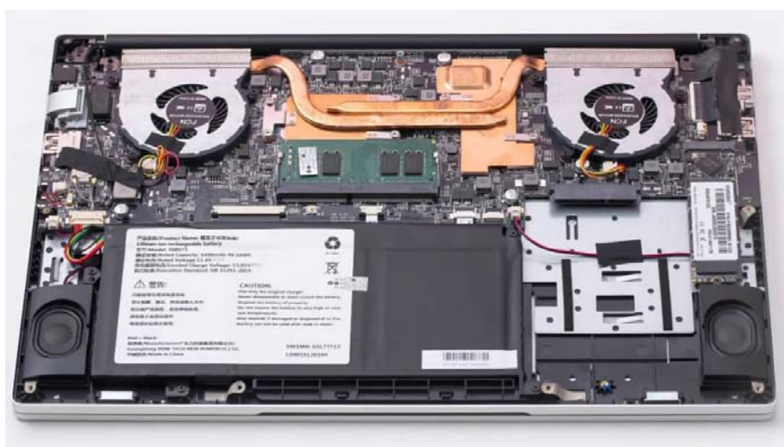
实机拆机图,双风扇双热管散热规格,预留2.5英寸SATA硬盘位,扬声器个头大
