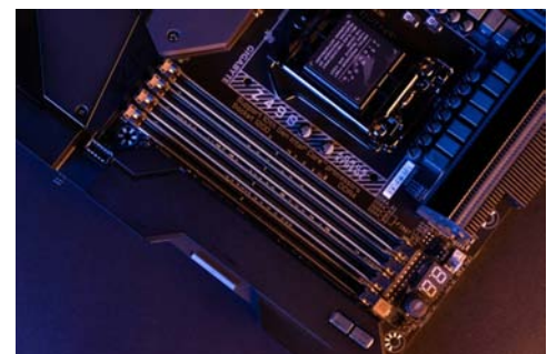
Z490 AORUS XTREME最多支持128GB内存容量,在XMP模式下最高可支持DDR4 5000+
