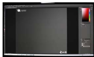
10bit 模式下图片过渡非常平滑(细纹为相机拍摄产生的摩尔纹)
