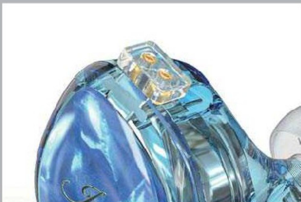
>> EA3采用了标准0.78mm双针可换线结构
