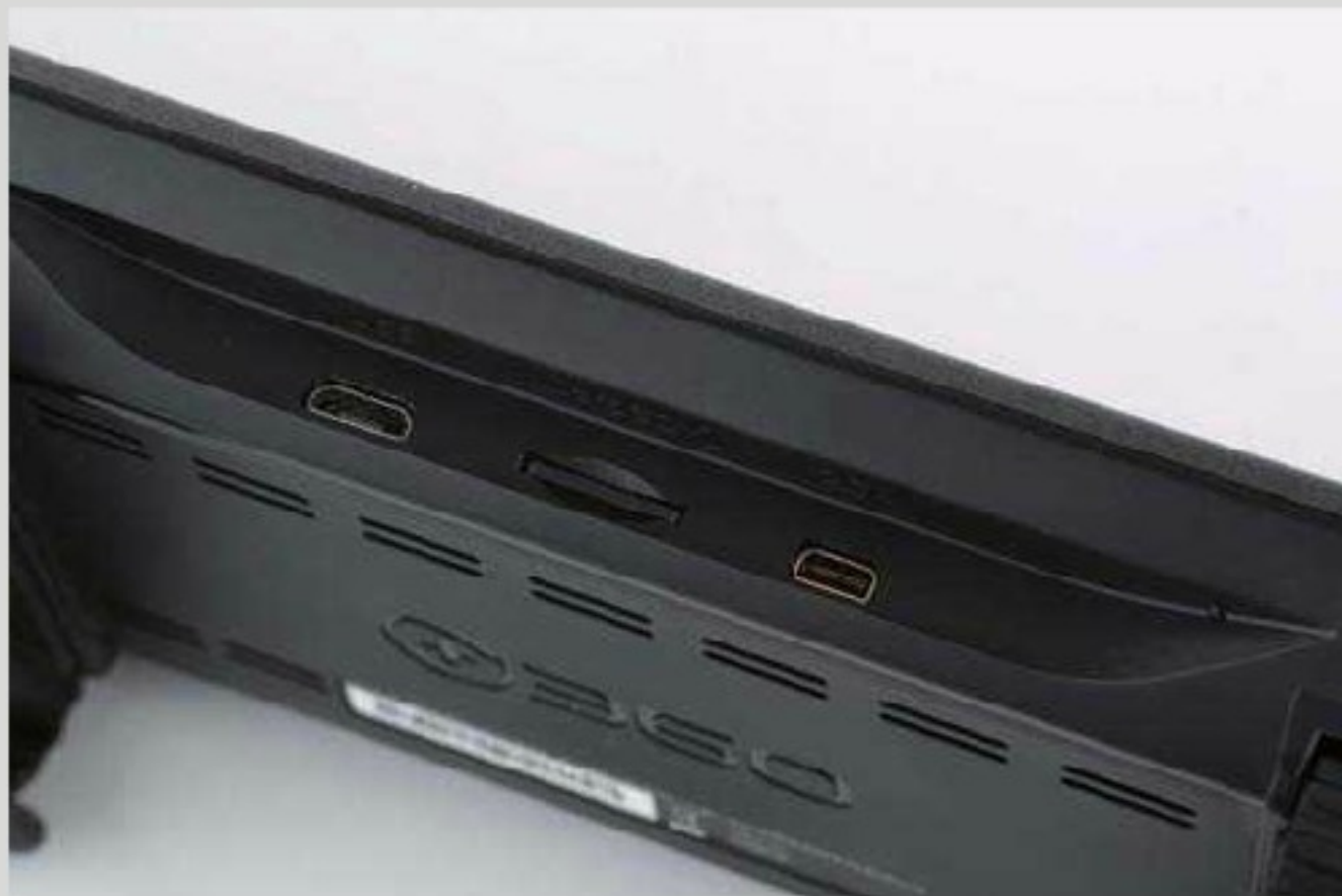
>> 接口插槽部分,从左到右依次为 Micro USB 供电接口、Micro SD 卡插槽、流媒体接口。
