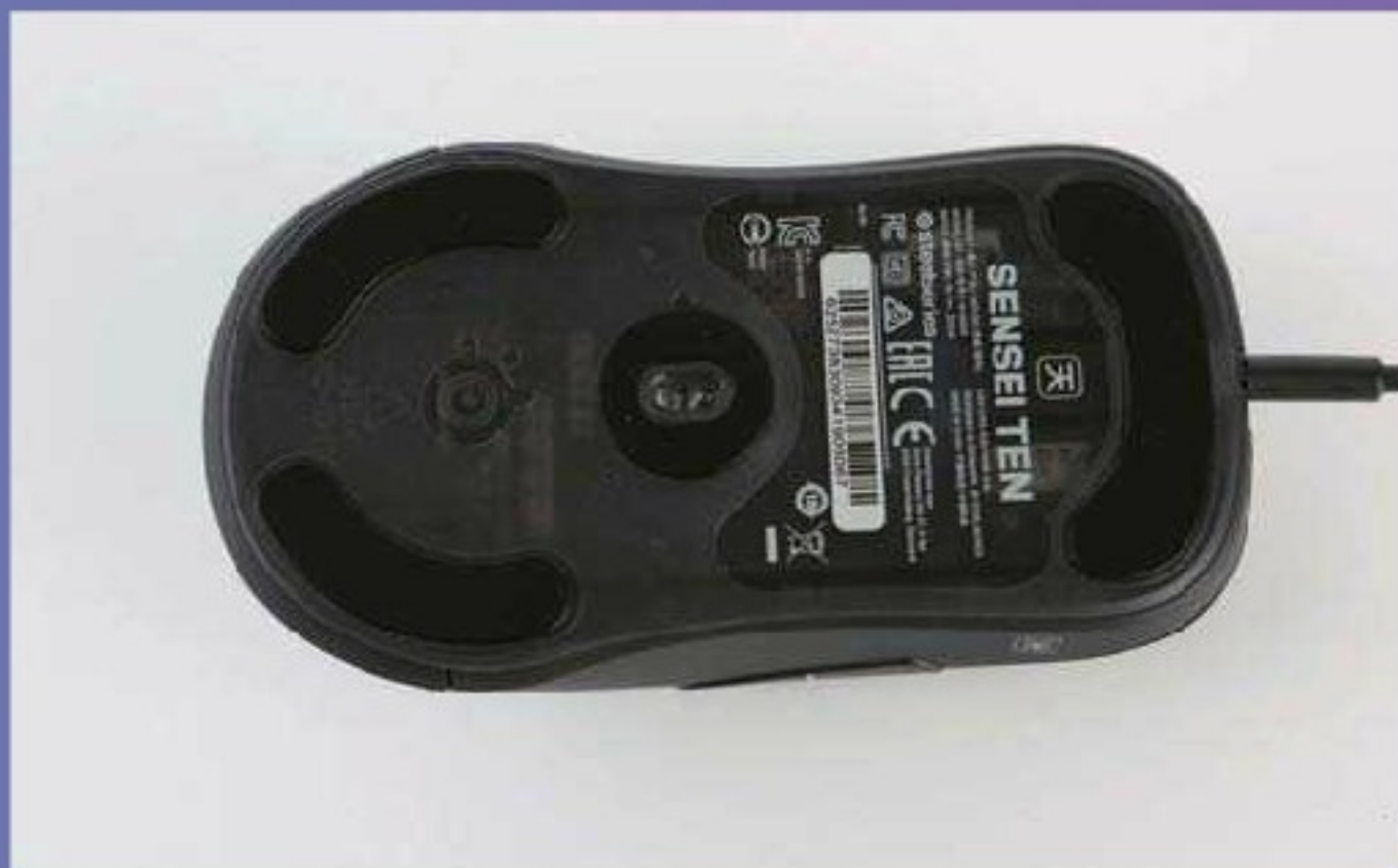
半透明的底部拥有三颗面积适中的特氟龙脚贴，在底部下方还印刻了一颗赛睿Logo用作装饰。
