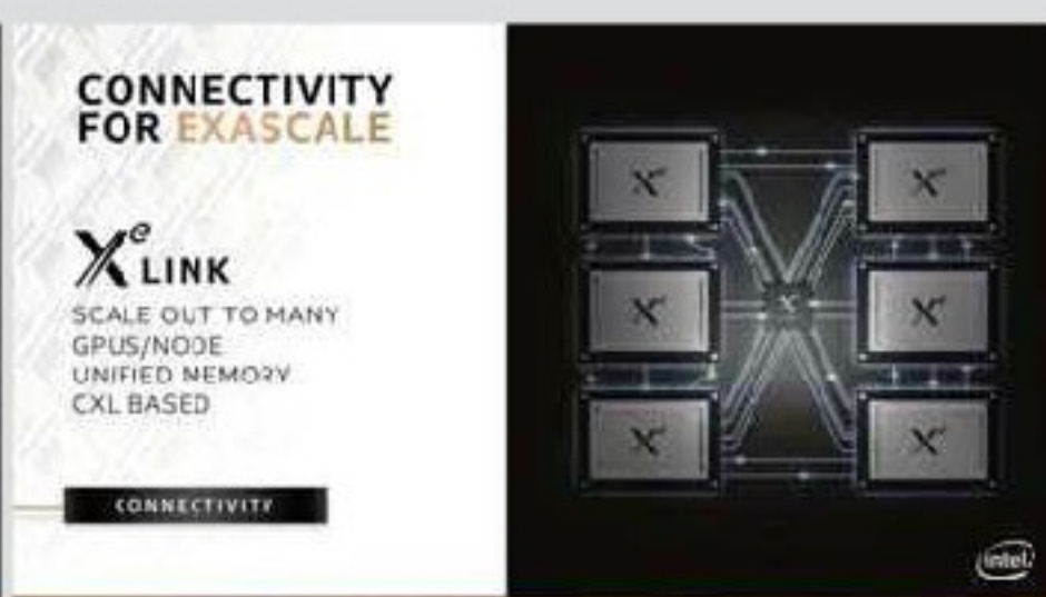
■ 为了让所有的GPU协同工作,英特尔开发了Xe Link芯片。
