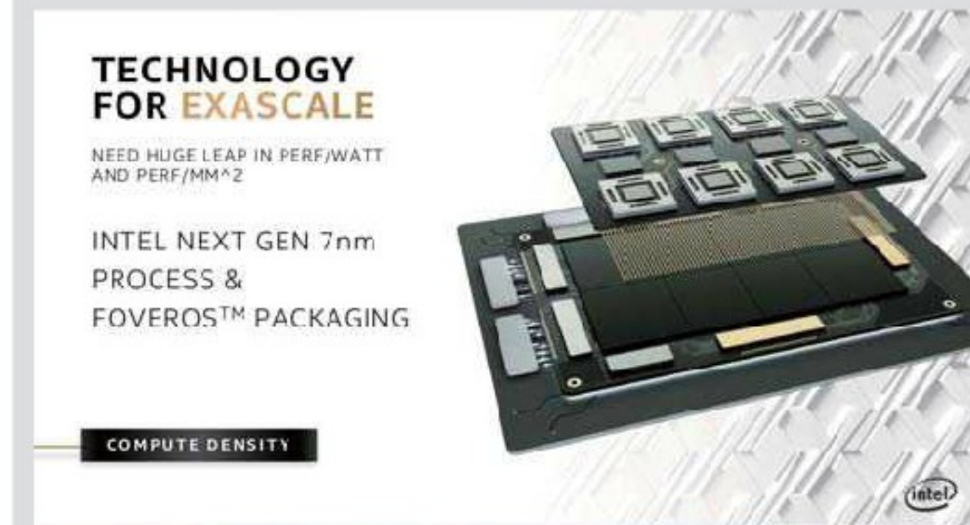
■ 英特尔展示PVC产品的封装结构，大量使用了7nm、EMIB和Foveros技术。
