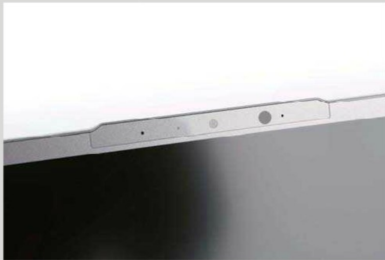
>> 屏幕顶部加入了一组红外摄像头，这一组红外摄像头支持 Windows Hello Camera 人脸识别，配合 Windows Hello 功能可便捷地登录系统。
