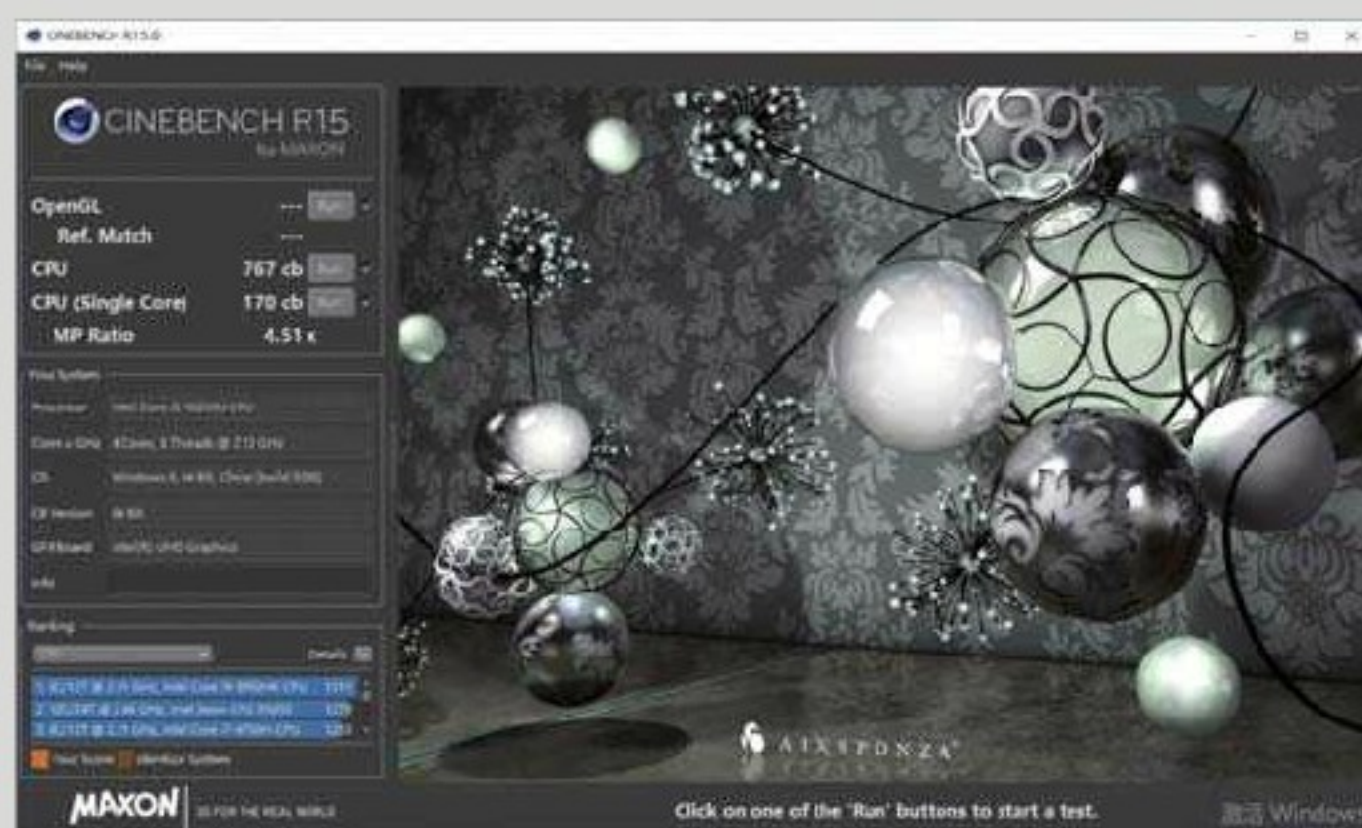
>> 在CINEBENCH R15处理器渲染性能测试中,这台机器取得单线程170cb、多线程767cb的亮眼成绩。
