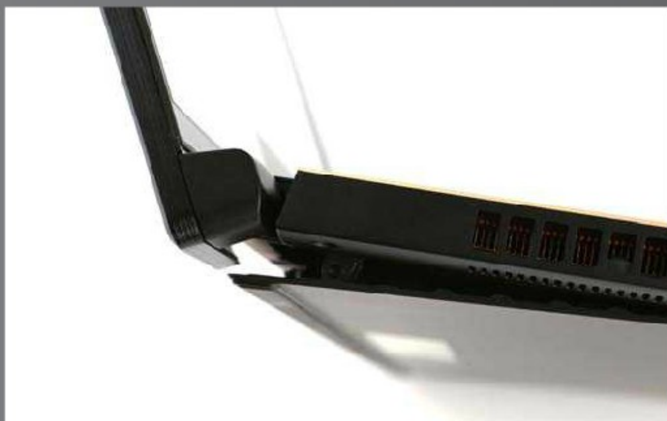
除了尾部的两个散热口，ROG冰刃3S Plus的底部采用了“张开式的散热出风口”设计，当这款游戏本打开之后，其底部会自动撑开一个大约5mm空隙的进风口。
