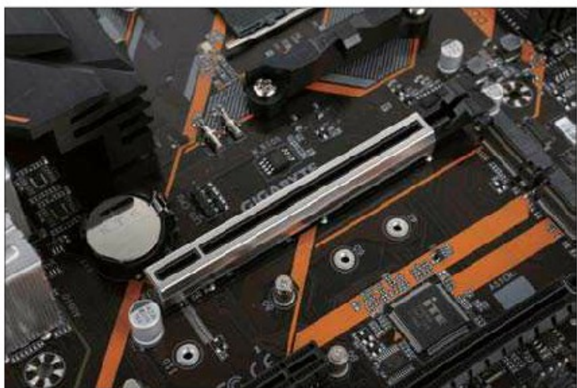
■ 主板的PCIe扩展插槽配备了“合金装甲”,可以提升PCIe插槽的强度。
