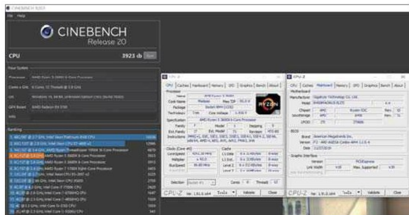
■ B450M AORUS ELITE主板可以将锐龙5 3600X的6颗核心全部超频到4.3GHz,带来强劲的性能表现。
