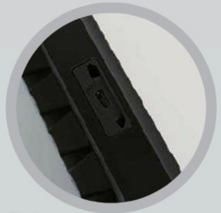
由于采用了可拆卸式USB的设计, 所以键盘身上还有一个Micro USB接口。
