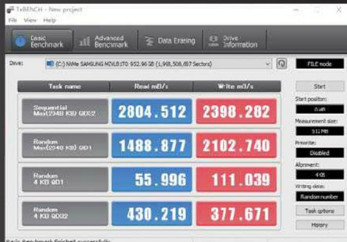
ROG冰刃3S PLUS在TxBENCH测试中，其NVMe SSD的连续读取速度高达2800MB/s以上，连续写入速度也逼近2400MB/s。
