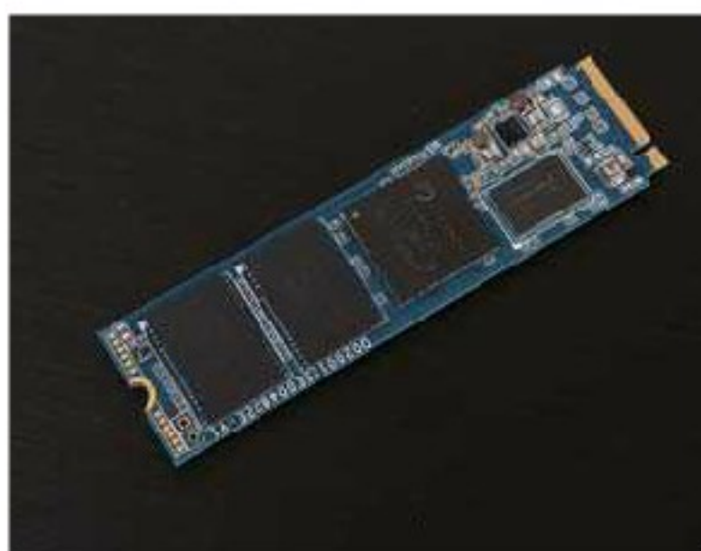
希捷酷玩固态510系列的PCB布局和前一款产品一致，缓存由正反两颗SK海力士DDR4缓存颗粒组成1GB容量。闪存颗粒则是正反一共4颗，总容量1TB，采用东芝64层堆叠BiCS3 3D TLC。
