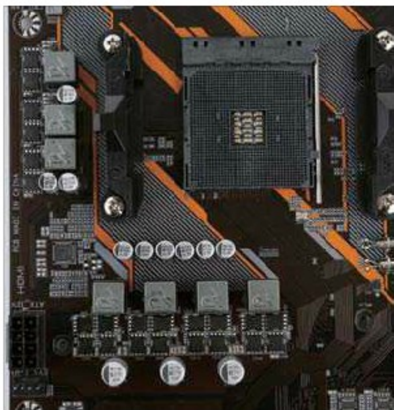
■ 主板采用4+3相供电设计,搭配安森美低内阻MOSFET、钰邦5K固态电容、雷电电感。
