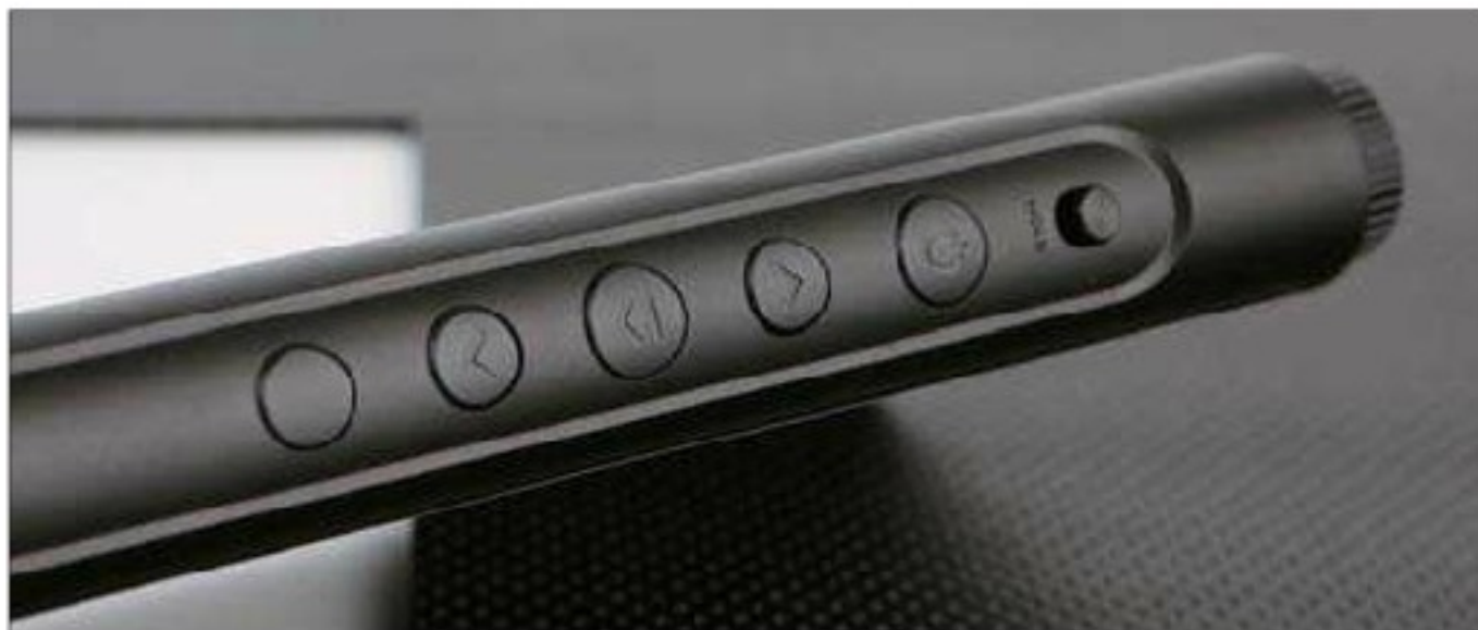
实体按键集中在机身左侧, 除了Hold滑动开关、电源开关、播放控制键之外, M15还提供了一个自定义功能键, 用户可以将它设置成自己最常用的功能, 实现一键开启/切换, 可以设置的功能包括添加最爱、切换EQ、蓝牙解码模式、USB解码模式等。
