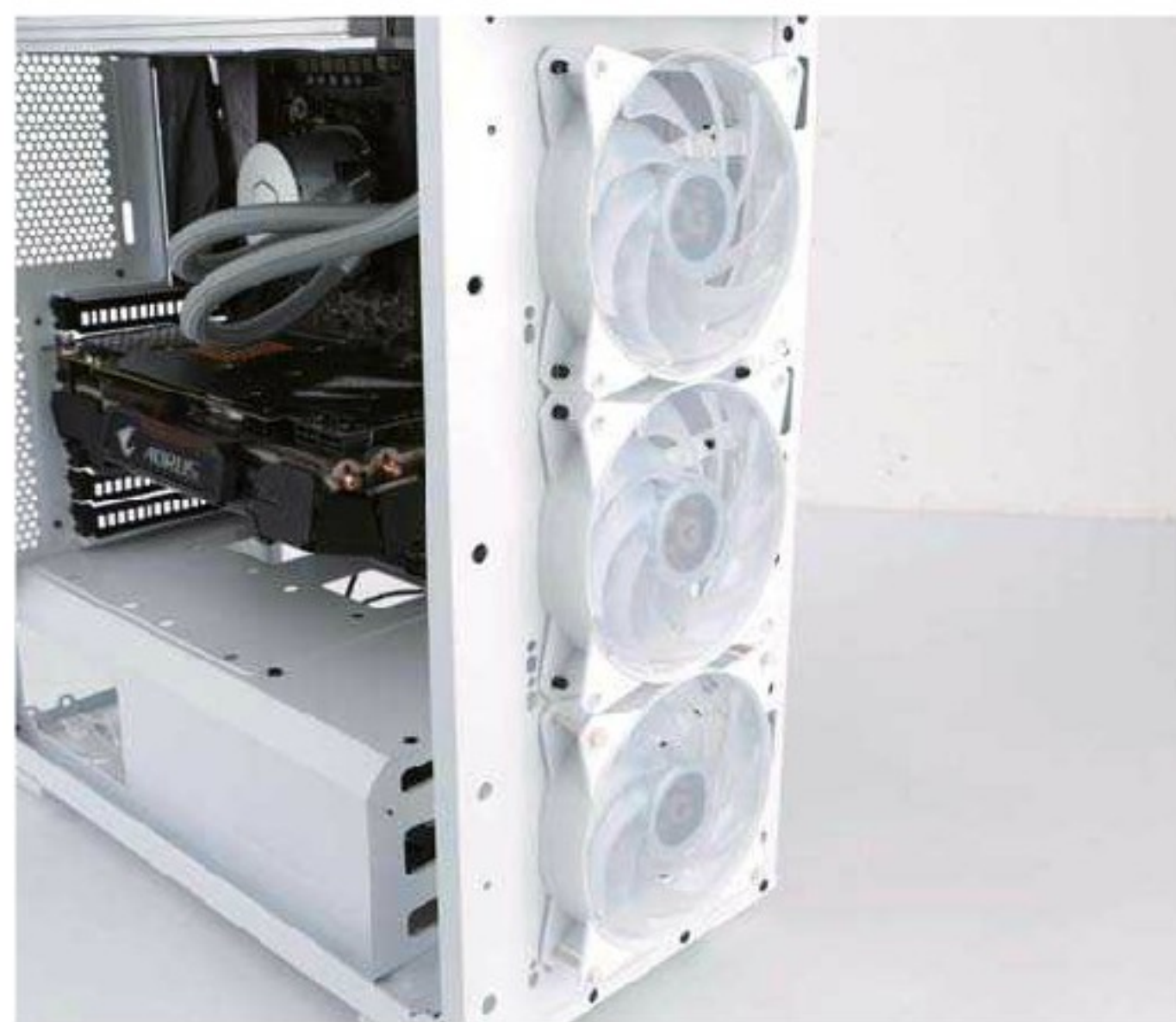
掀开机箱前面板后可以看到里面预装有三个120mm的ARGB风扇
