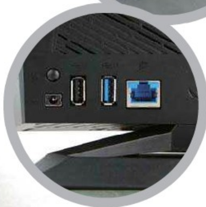
■ GT-AC2900提供了一个千兆WAN口和4个千兆LAN口，其中LAN1为ROG电竞端口，连接在该接口上的设备数据会被优先传输，同时LAN1和LAN2支持链路聚合，网络端口都有金属屏蔽罩包裹，做工扎实。此外它还提供了USB 3.0和USB 2.0接口各一个方便用户连接移动存储等设备。
