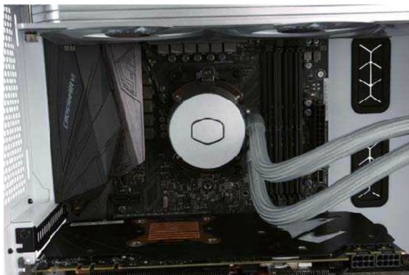
顶部安装的360mm规格的一体式水冷,水管不会干扰到内存。
