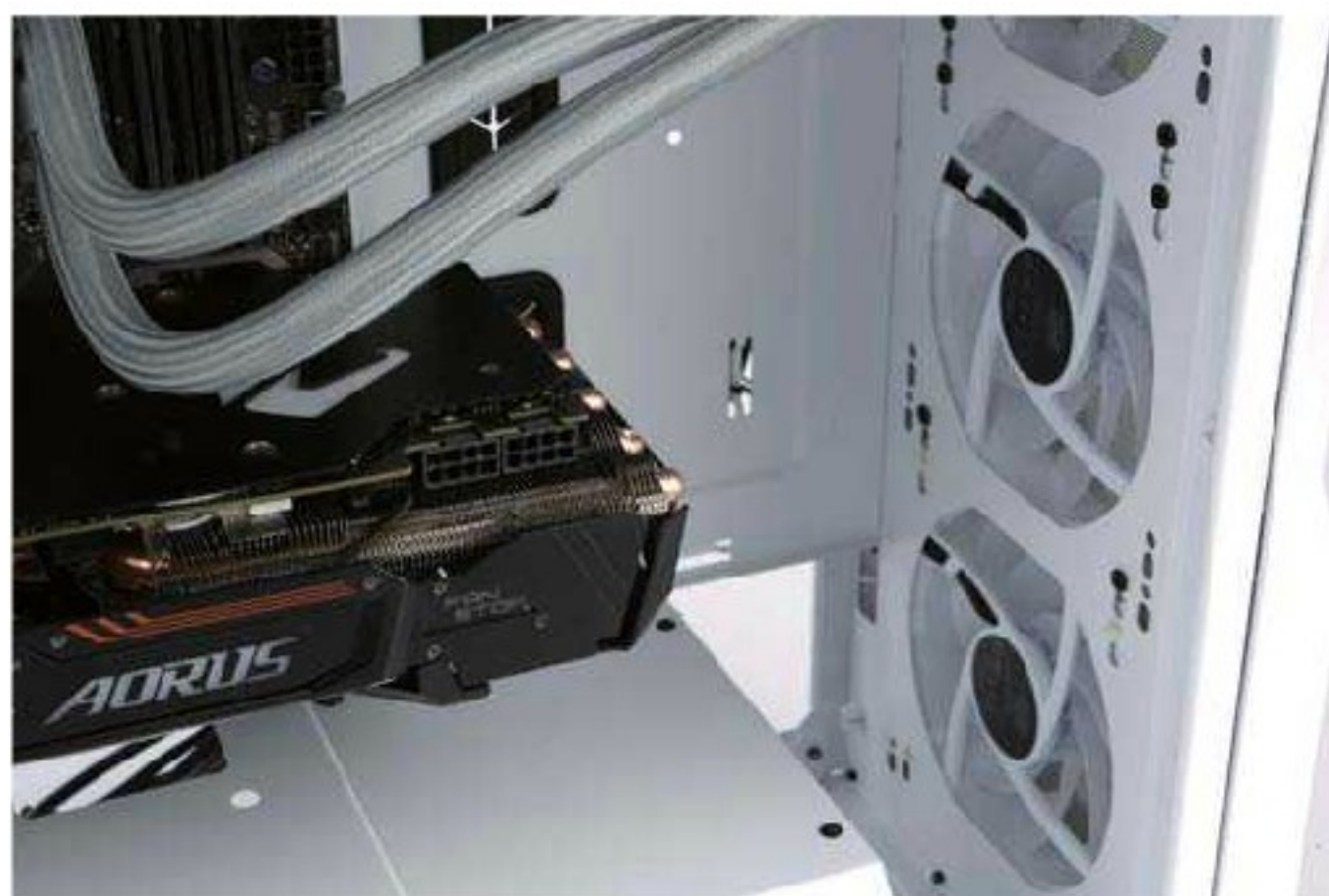
显卡顶端距离机箱前部有12cm的距离,对旗舰级显卡兼容性很好。
