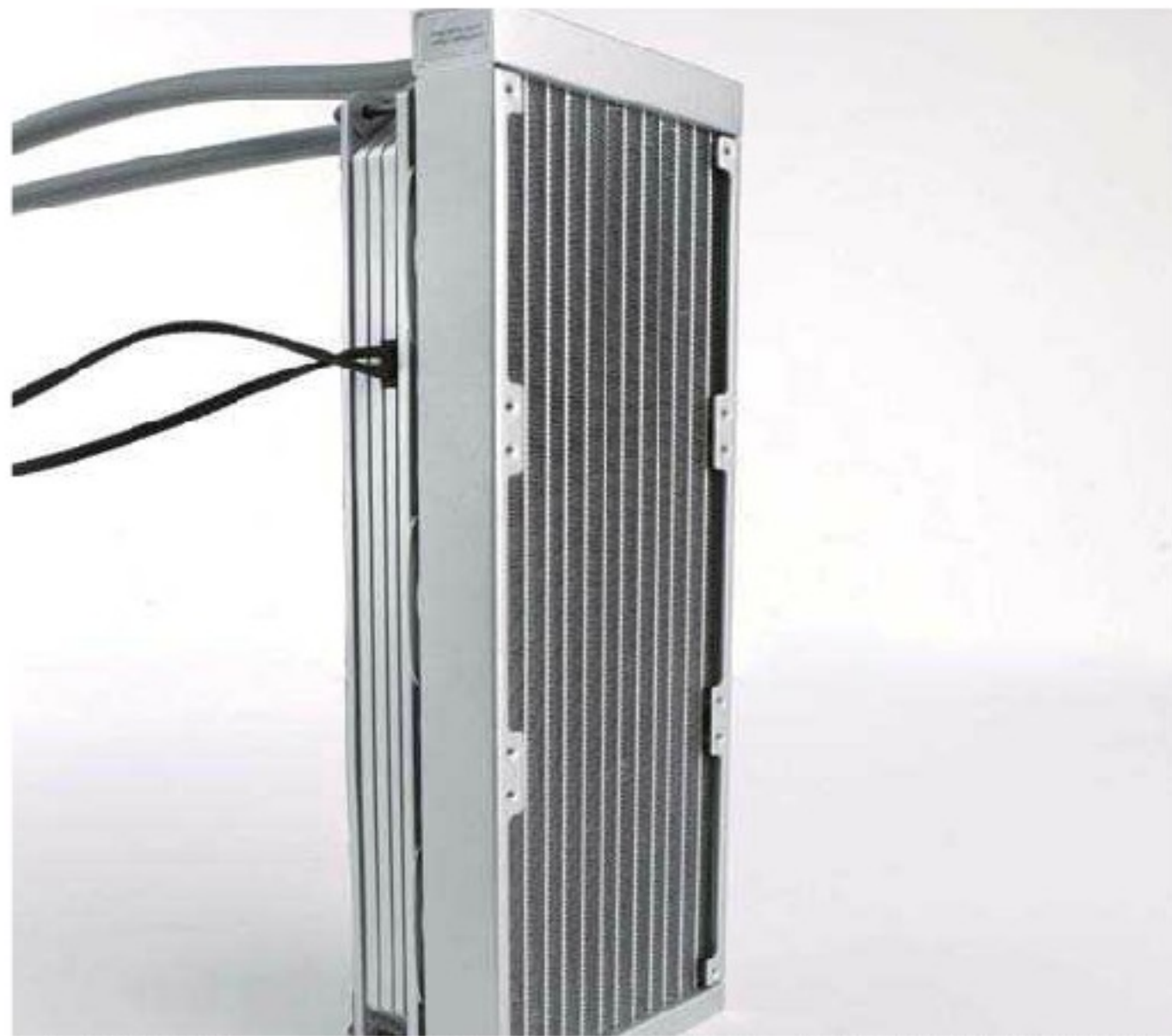
❑ 冷排的厚度为2.7cm左右，散热鳍片排列整齐，间隙均匀。同时水管部分的外部采用的尼龙编织线进行了包裹，确保在弯折的同时拥有更好的韧性。
