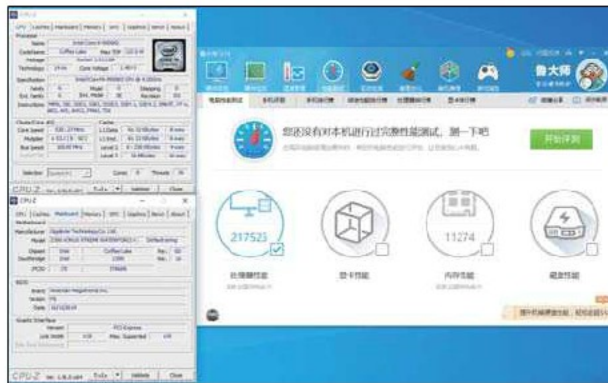
在5.3GHz，酷睿i9-9900KS可以完成负载较低的CPU-Z与《鲁大师》处理器性能测试。
