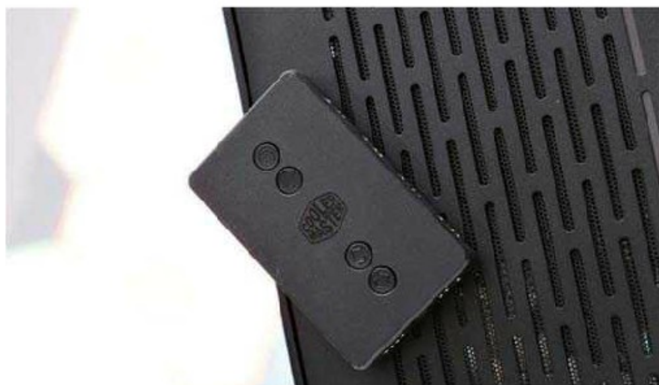
酷冷至尊冰神P360 ARGB搭配的一个灯效控制器, 通过这个控制器即便是主板不支持灯效也能对灯效进行切换。
