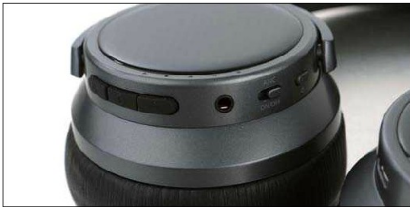
耳机的按键集中在右侧耳罩下方, 包括电源开关、播放控制、音量调节以及降噪开关。此外它还提供了一个3.5mm接口, 在没电的时候可以通过它变身有线耳机继续使用。
