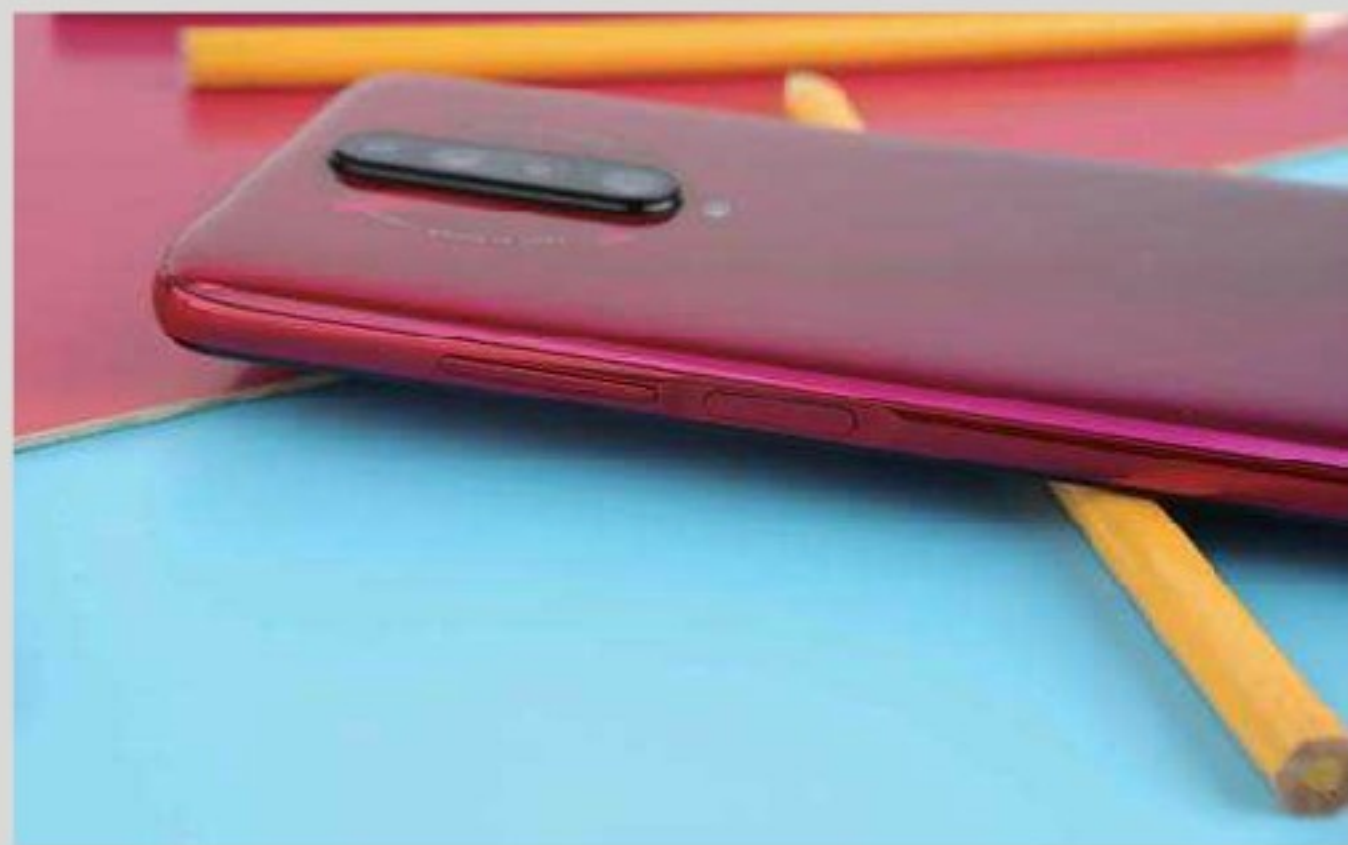
>> 采用侧边指纹设计，指纹模块和电源键合二为一，识别速度和准确率都很不错。
