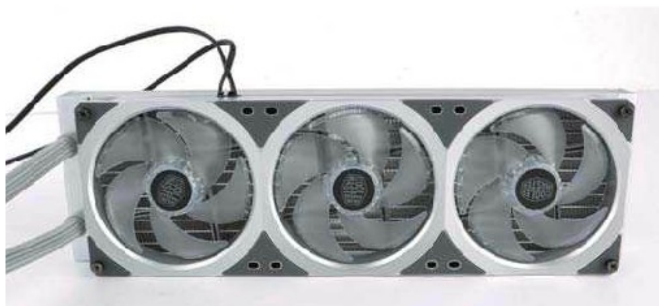
采用的一体式3风扇, 线缆通过串联, 最终只有两根线缆, 理线、接驳更方便。
