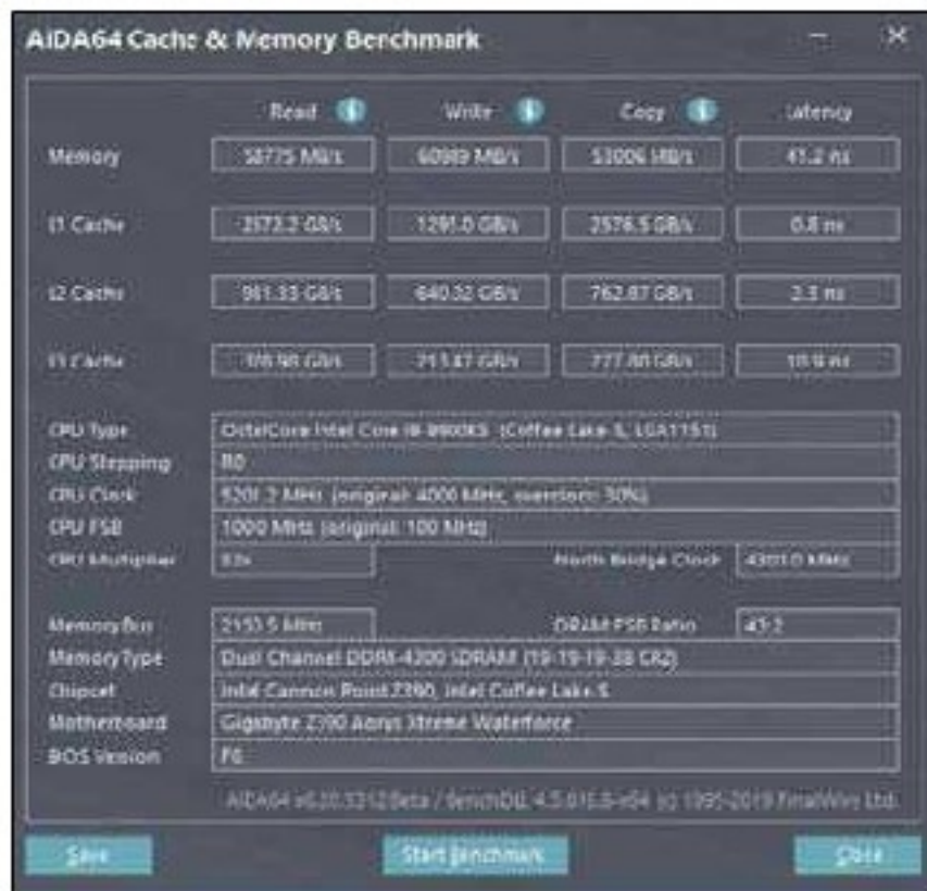
TRIDENT Z NEO(焰光戟)内存超频到DDR4 4300后,各项内存带宽提升显著,内存延迟也有小幅降低。
