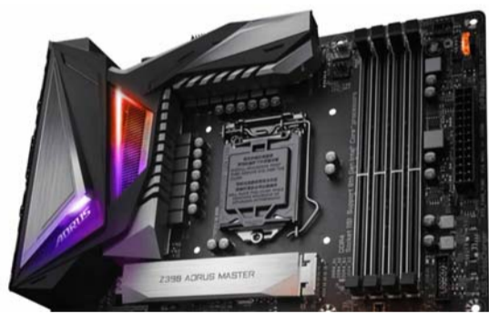
Z390 AORUS MASTER 配备 12+2 相服务器级供电,为 Core i9 9900KS 提供充足稳定的电力
