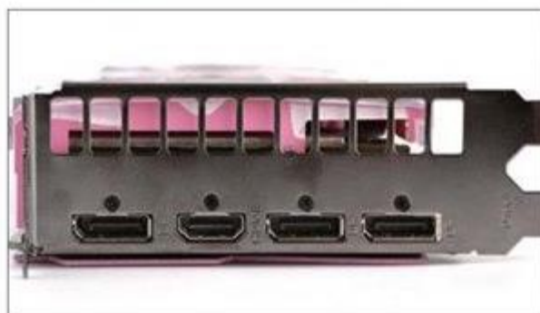
影驰GeForce RTX 2060 Super星耀的视频输出面板上配备了3个DP 1.4接口和1个HDMI 2.0b接口
