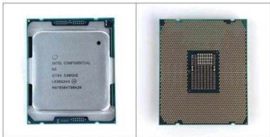
■ 酷睿i9-10980XE工程版处理器，仍采用LGA 2066封装，在外观上与酷睿i9-9980XE相比没有明显不同。
