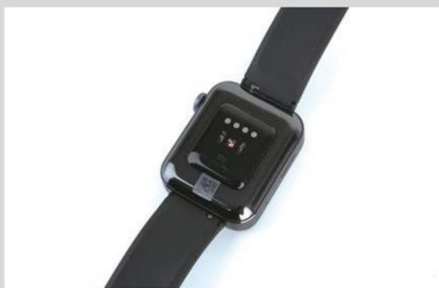
>> 背部集成多种传感器，上面四个金属圆点为充电触点。
