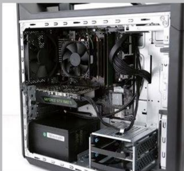
>> 主机前后面板内部各配备了一个120mm PWM无级调速风扇,可构建畅通、高效的风道。
