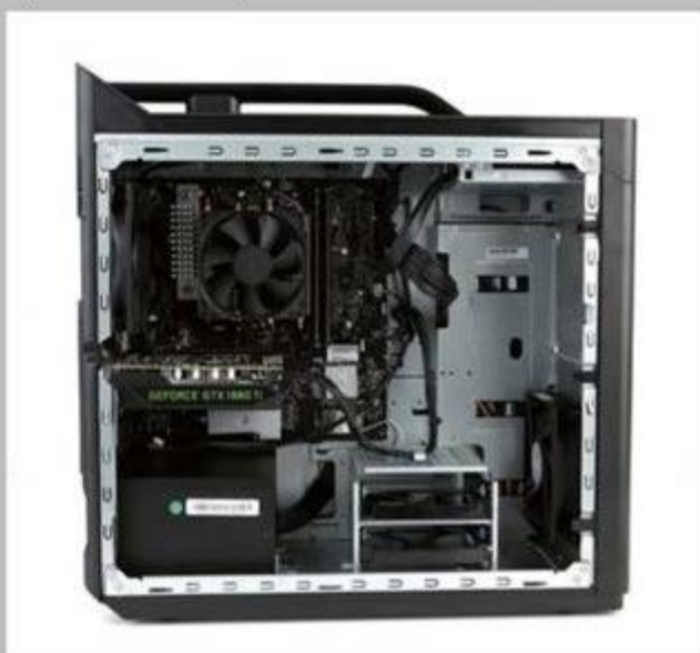
>> 低配的“畅享版”主机内部也配备了锐龙5 3600处理器、105W热管散热器、双通道16GB内存,以及512GB PCIe SSD, GeForce GTX 1660Ti 显卡。
