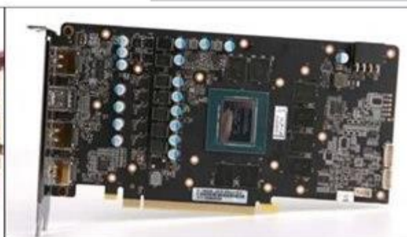
影驰GeForce RTX 2060 Super星耀采用5+2相供电设计, GPU型号为TU106-410-A1, 并搭载8颗来自美光的GDDR6显存。
