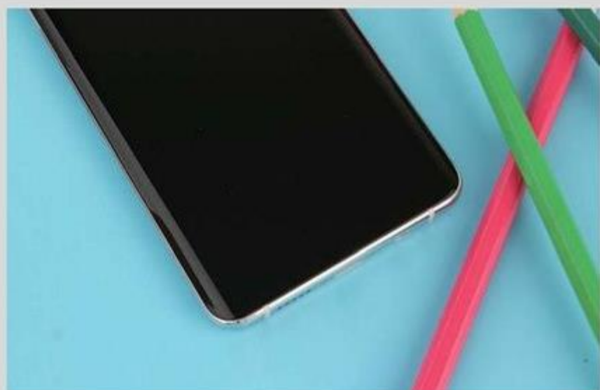
>> 搭载 6.47 英寸双曲面屏，通过德国莱茵低蓝光认证，COP 封装工艺让它拥有 3.43mm 的窄下巴。
