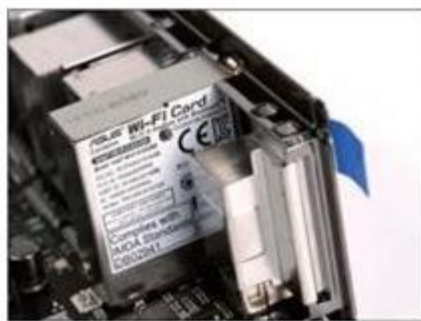
■ 主板配备了带宽为2.4Gbps的英特尔Wi-Fi 6 (802.11ax)AX200无线网卡
