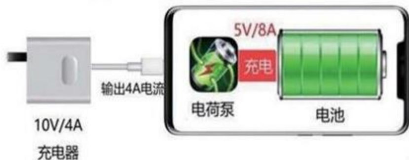
华为40W超级快充电荷泵原理示意图
