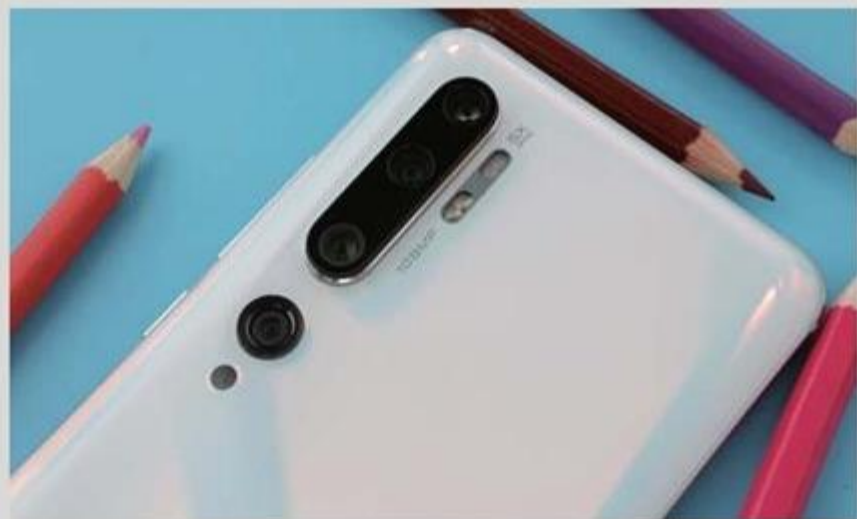
>> 后置五颗摄像头，包括超长焦摄像头（支持 10 倍混合变焦和 50 倍数码变焦）、1200 万像素 50mm 经典人像镜头、一亿像素主摄像头、2000 万 117° 超广角摄像头和超近微距摄像头。配备了 4 个 LED 补光灯。
