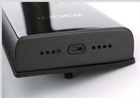
>> 面板底部有可供临时供电的 Micro USB 接口，如果换成现在更流行的 USB Type-C 接口会更好。
