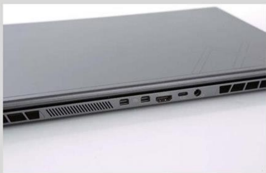
>> 背部设计有两个 MiniDP 接口、一个 HDMI 接口、一个 USB Type-C 接口以及电源接口。
