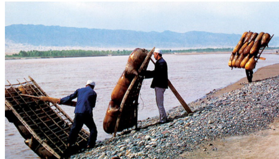
羊皮筏，是古代沿袭至今的黄河摆渡工具。古时，人们“缝革为囊”，充入空气，泗渡用。唐代时，这种工具被称为“革囊”。到了宋代，皮囊是宰杀牛、羊后掏空内脏的完整皮张，不再是缝合而成，故改名为“浑脱”。
